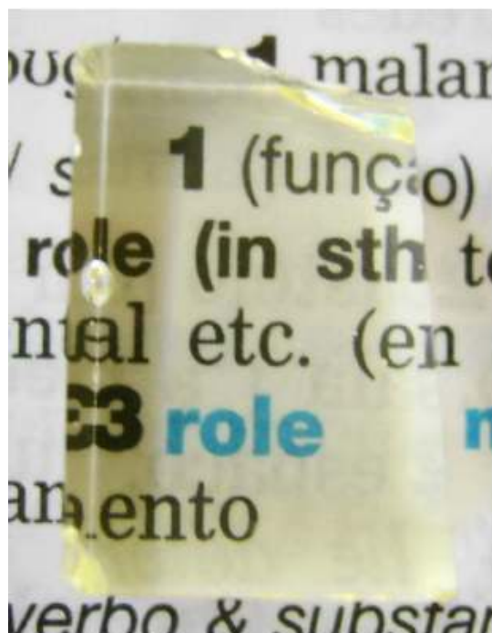
Figura 11: Vidro 50\text{B}_2\text{O}_3\text{-}35\text{PbO}\text{-}15\text{PbF}_2 obtido após o tratamento térmico.
