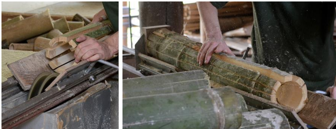
Figura 73. Colmos sendo refilados.
