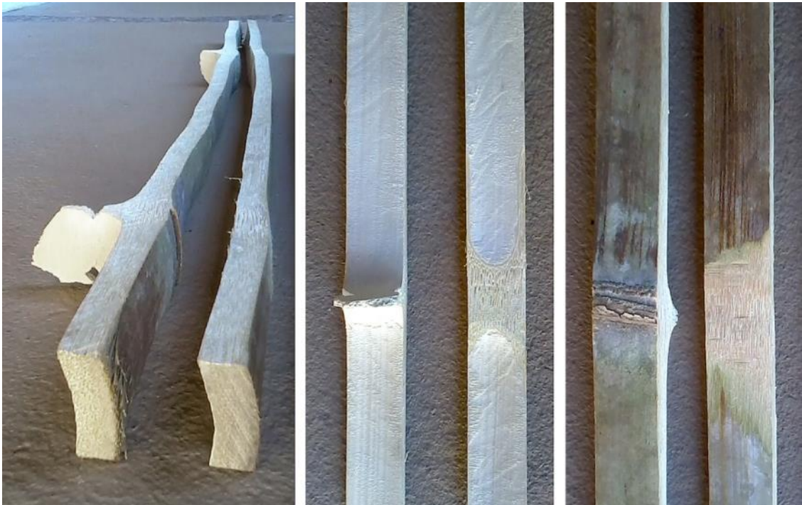
Figura 77. Detalhes de duas ripas antes e depois da retirada dos nós e diafragmas.
