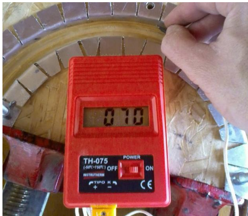
Figura 101. Medição da temperatura do molde.
