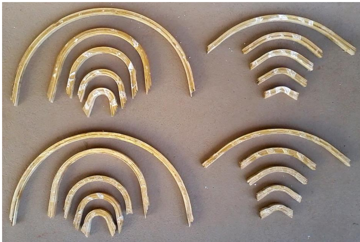
Figura 117. Peças obtidas com as prensagens em cada um dos moldes, para os dois tipos de adesivos.
