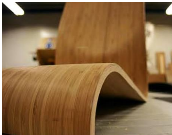
Figura 29. Amostra de um assento de BLaC curvo feito com folheado de bambu.
