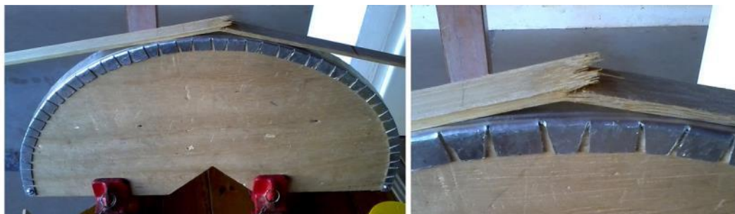
Figura 116. Teste com lâmina contendo nó no centro da peça.
