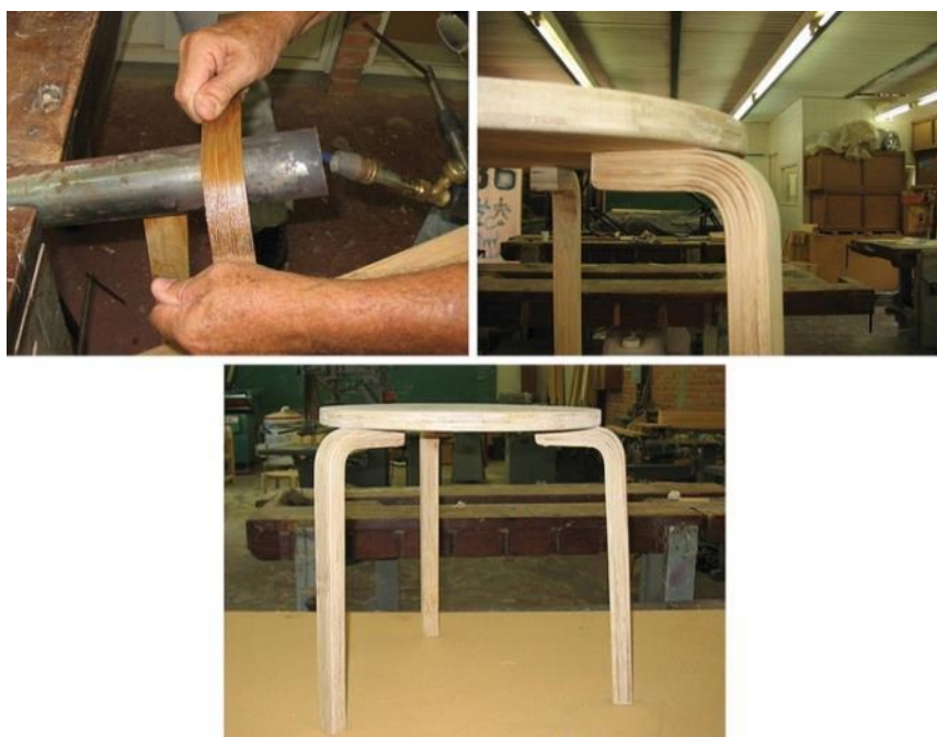
Figura 33 – Curvatura das ripas de bambu e o banco finalizado.
