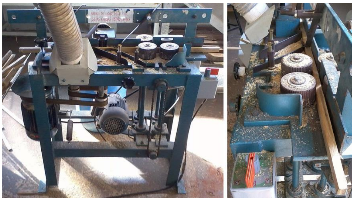
Figura 89. Plaina duas faces própria para bambu.
