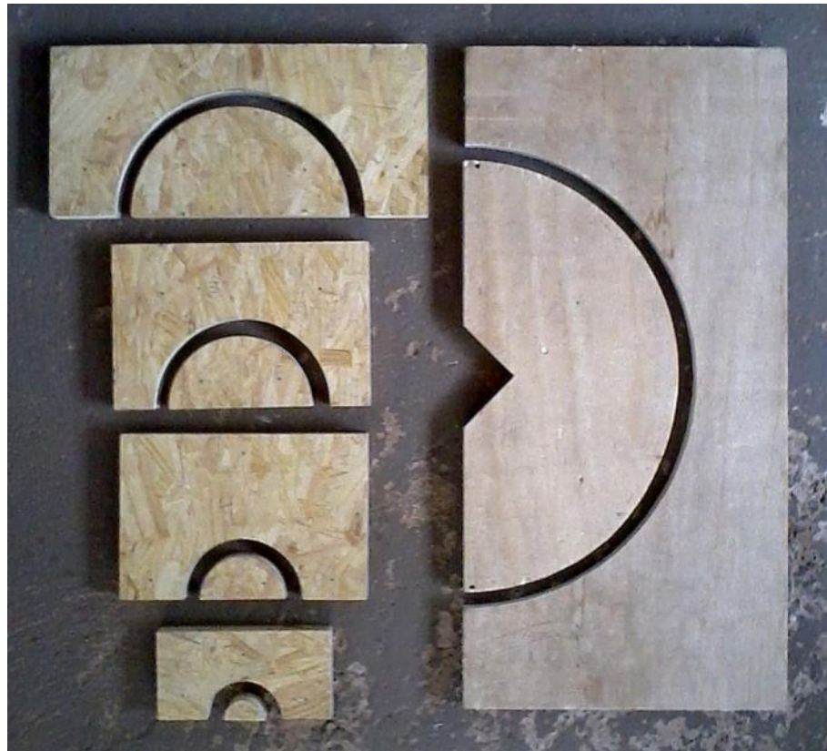
Figura 87. Moldes com abertura de 180° finalizados.
