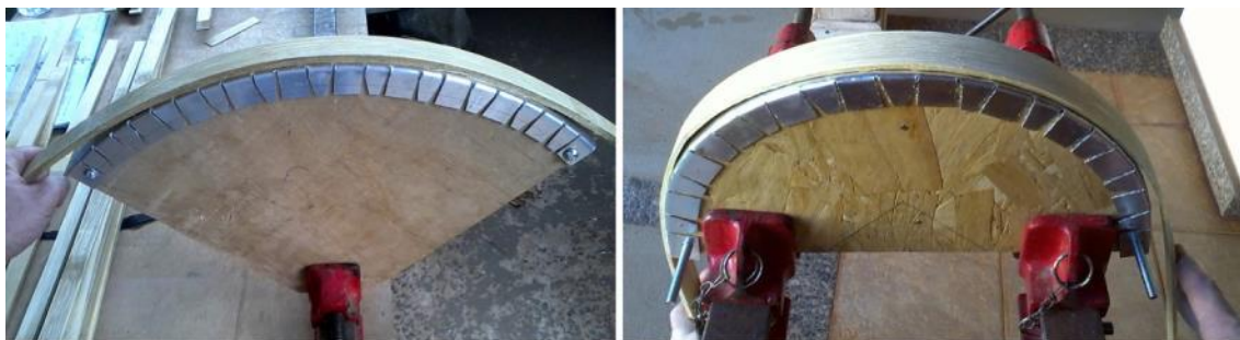
Figura 91. Teste manual da espessura das ripas.
