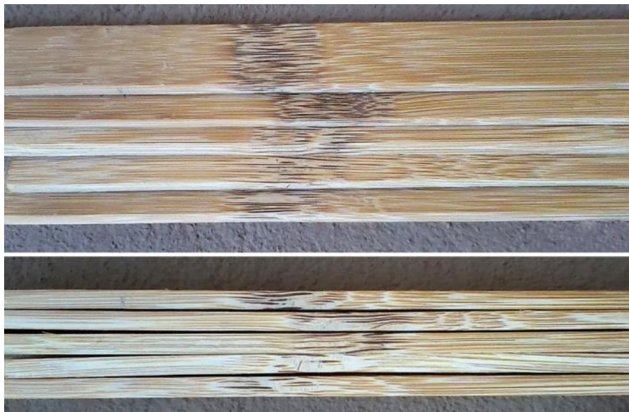
Figura 97. Modo que deve ser evitado ao se dispor as lâminas para colagem.
