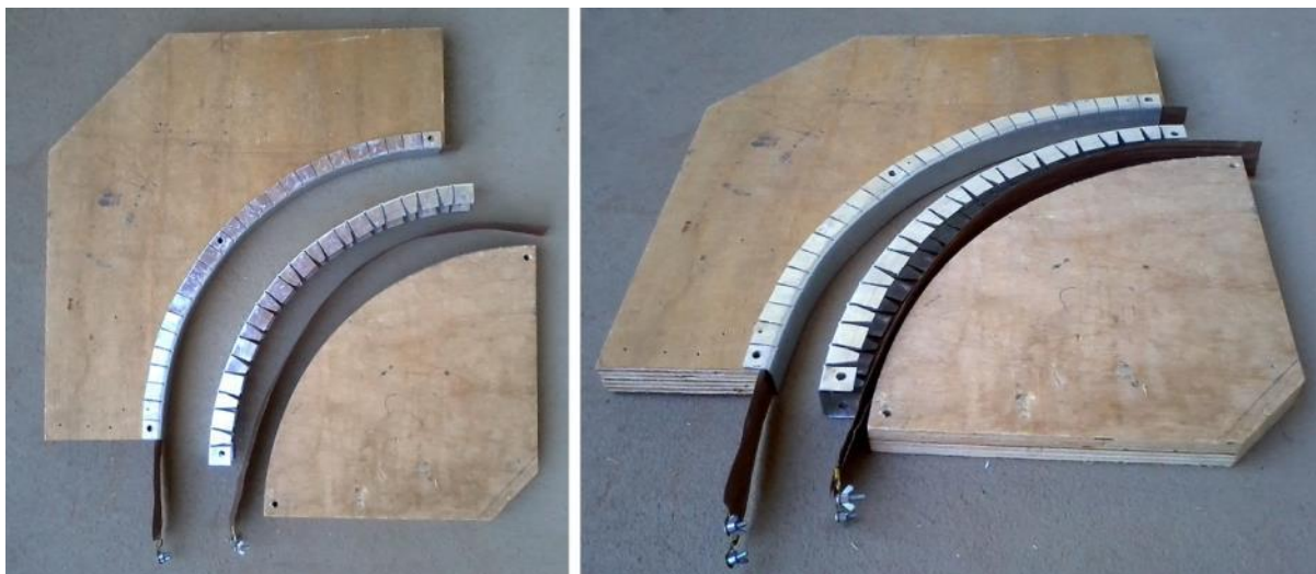
Figura 114. Molde finalizado com as fitas de aquecimento.
