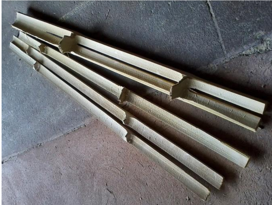
Figura 76. Ripas separadas manualmente.
