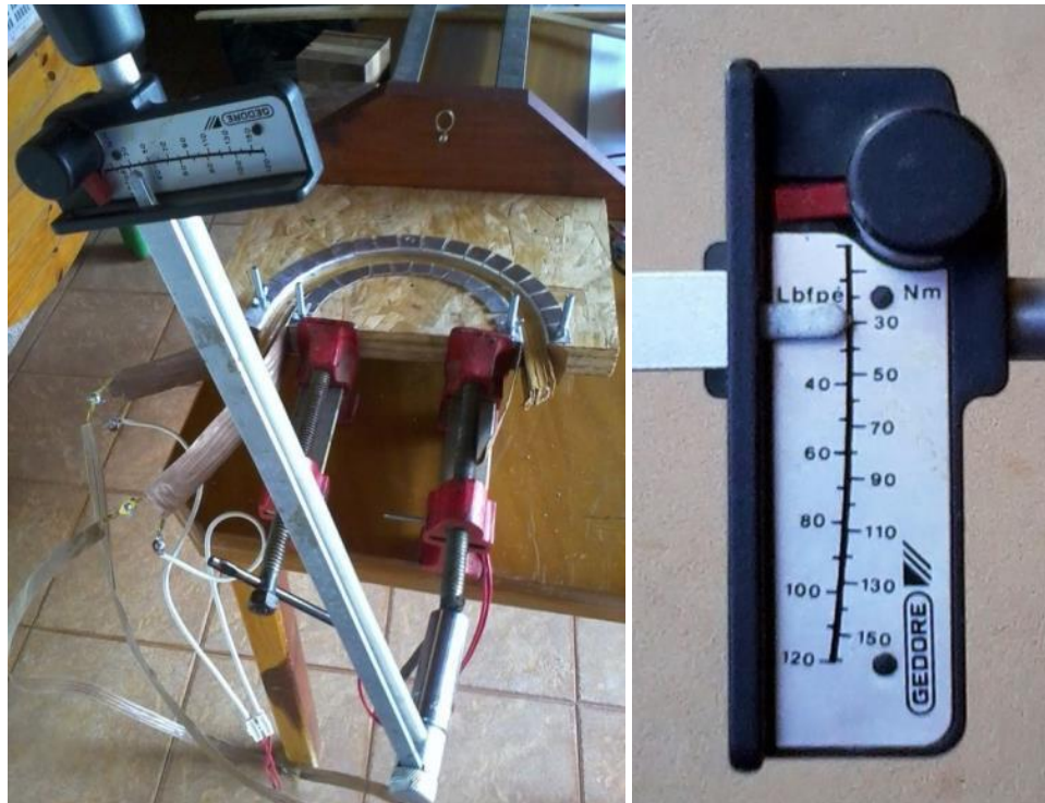
Figura 100. Torquímetro sendo utilizado e detalhe do ajuste para o torque de 30 Nm.
