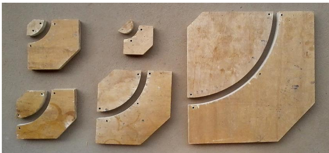
Figura 86. Moldes com abertura de 90° finalizados.
