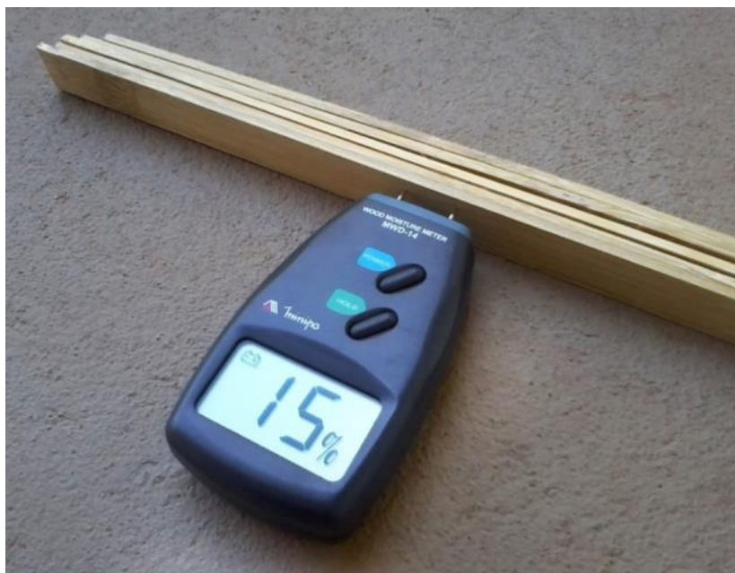
Figura 94. Medição da umidade das lâminas.
