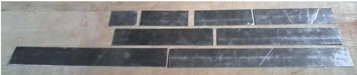
Figura 107. Tiras de alumínio cortadas nas medidas necessárias.
