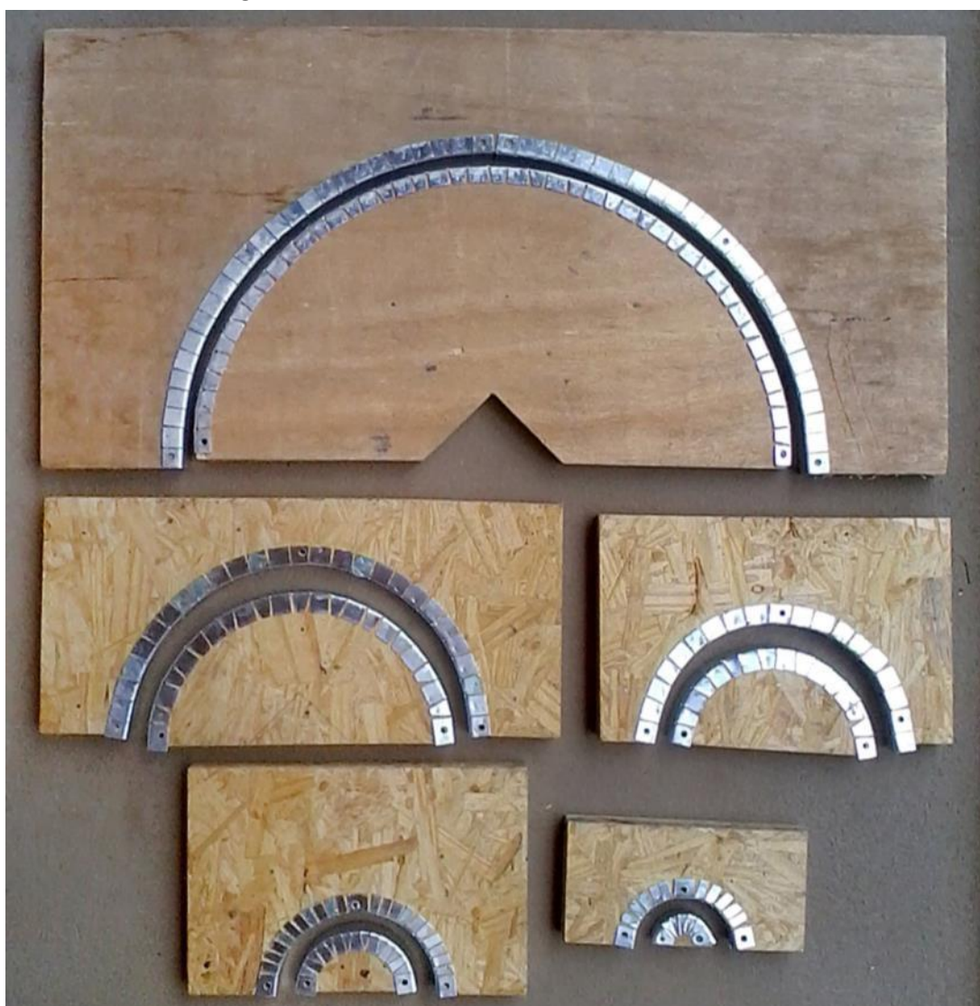
Figura 110. Moldes de 180° de abertura finalizados.
