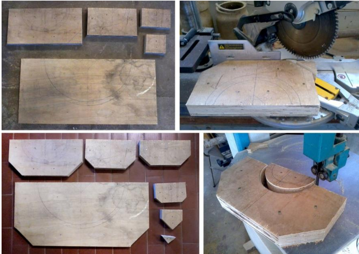
Figura 81. Confeção dos moldes.
