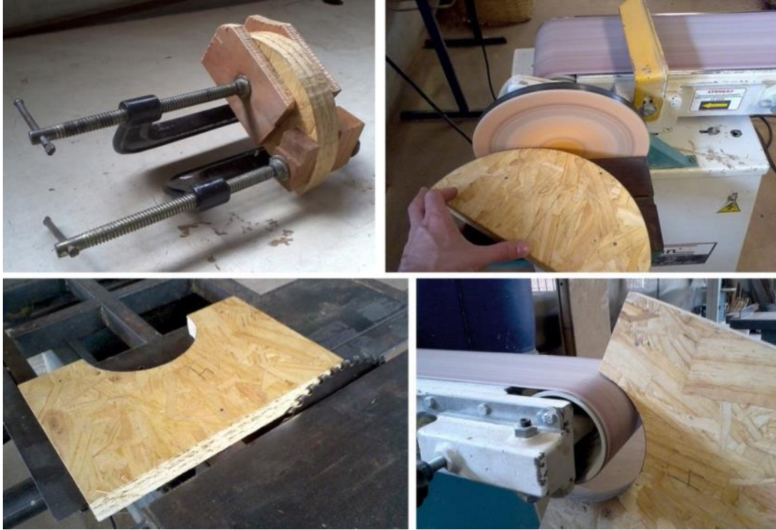
Figura 83. Confeção dos moldes macho-fêmea.
