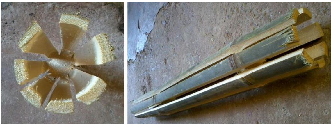
Figura 74. Colmo após o refilamento.
