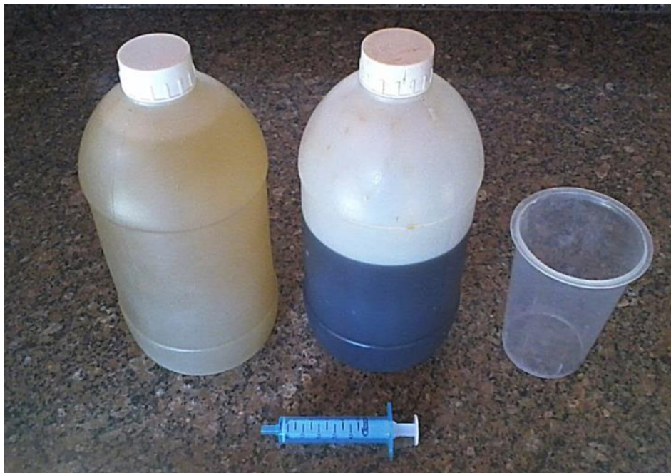
Figura 92. Itens para preparação do adesivo de óleo de mamona.
