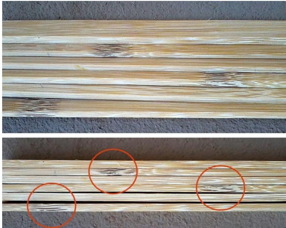
Figura 98. Modo recomendado de se dispor os nós das lâminas.
