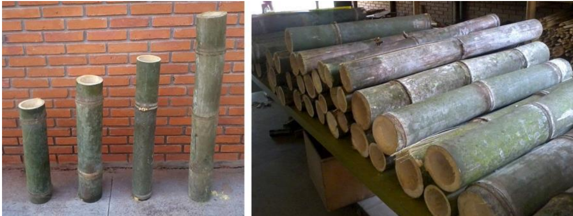
Figura 72. Colmos cortados nas medidas necessárias.
