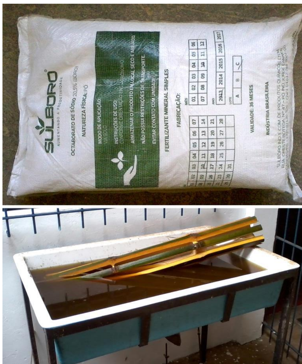
Figura 75. Produto octaborato de sódio e tanque de tratamento por imersão.
