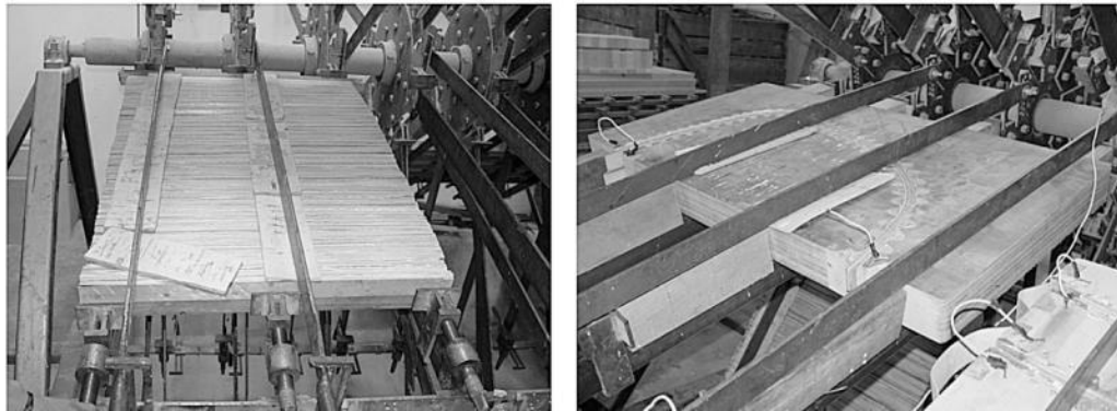
Figura 31. Lâminas sendo prensadas, após colagem.
