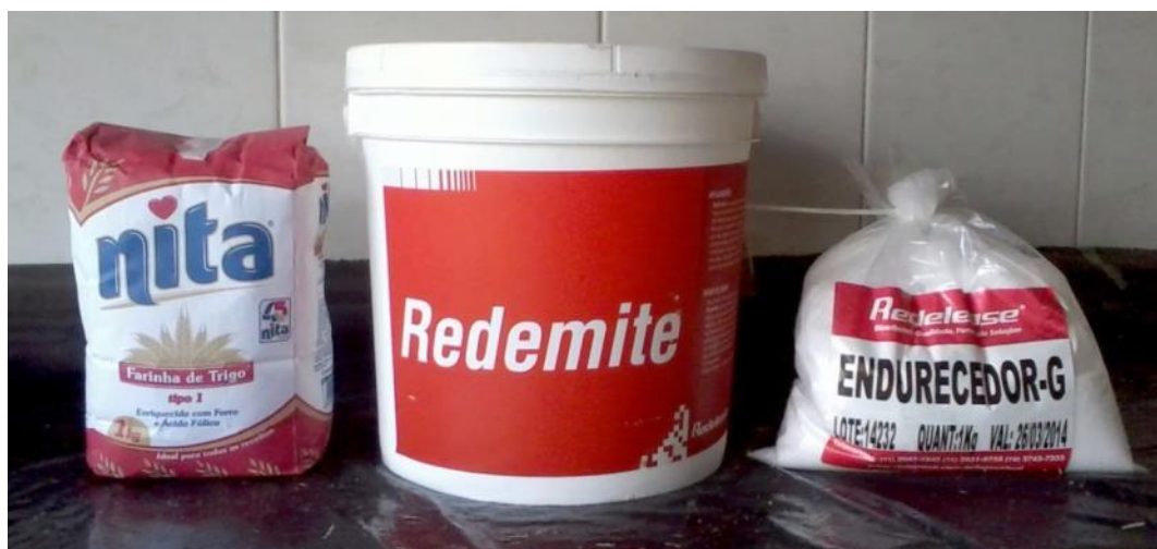
Figura 93. Itens para preparação do adesivo de UF.
