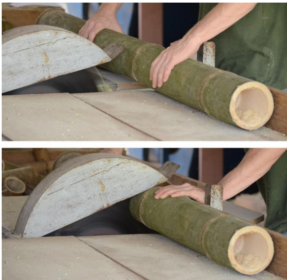
Figura 71. Corte da seção do colmo em serra circular destopadeira.
