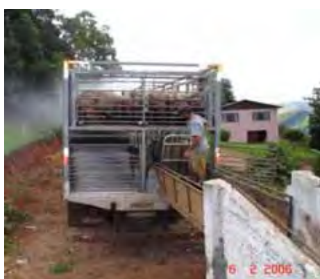
Figura 3 e 4 - Método de embarque para suínos na granja utilizando o modelo do veículo com carroceria com piso móvel.
