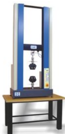
Figura 9 - Máquina de ensaio universal Instron Emic DL 2000
