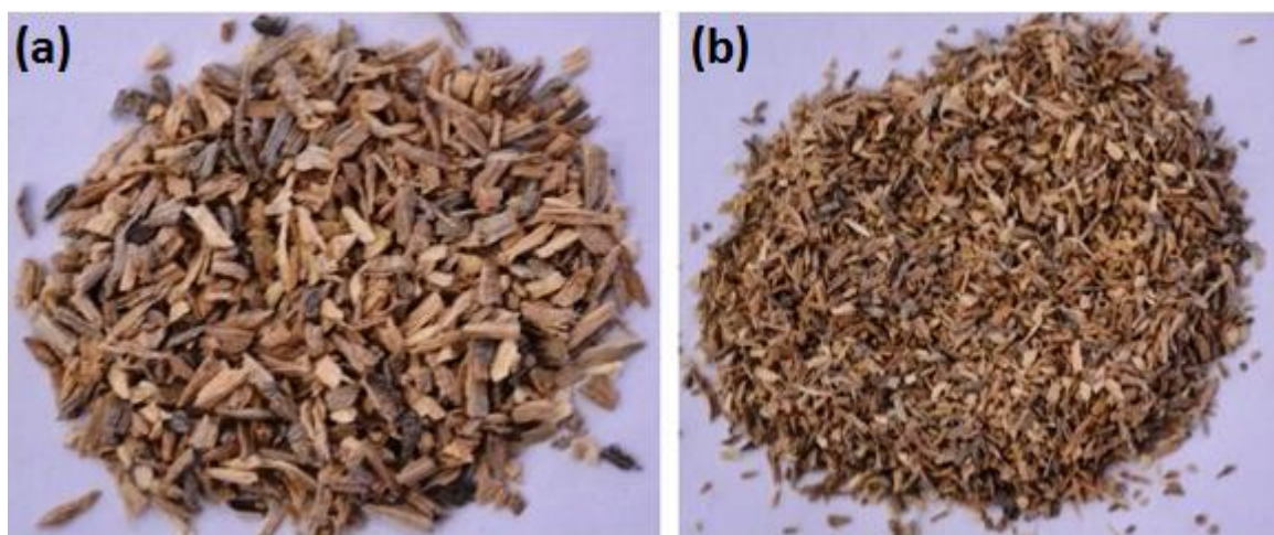
Figura 7- Partículas utilizadas para produção dos painéis 20 mesh (a) e 32 mesh (b)
