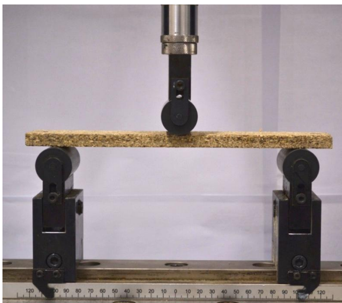
Figura 20- Aparato montado para o ensaio de flexão
