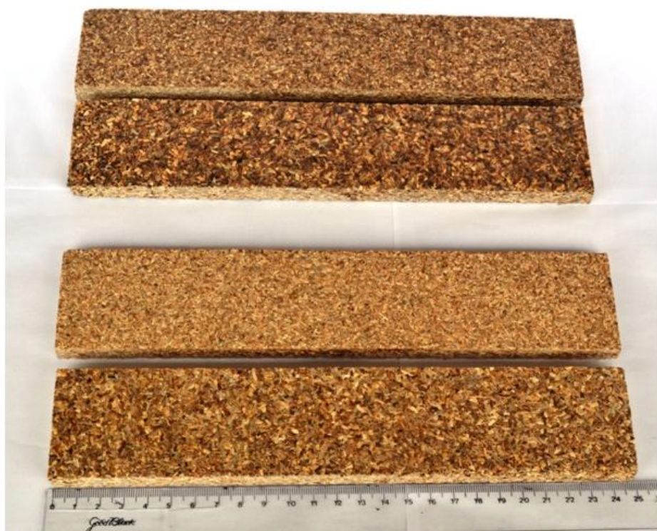
Figura 19- Corpos de prova para o ensaio de flexão estática, referentes aos tratamentos HomoUF, HetUF, HomoPU e HetPU, de baixo para cima, respectivamente
