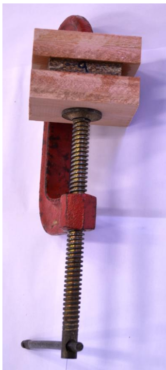
Figura 22- Colagem das sapatas nos corpos de prova para ensaio de adesão interna
