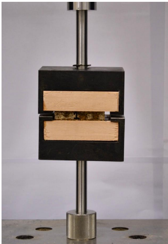
Figura 23- Conjunto montado para o ensaio de adesão interna.
