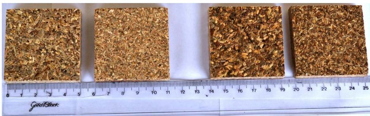
Figura 16 - Corpos de prova de teor de umidade e densidade, referentes aos tratamentos HomoUF, HetUF, HomoPU e HetPU, da esquerda para a direita, respectivamente.
