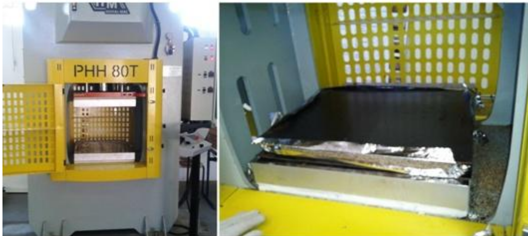
Figura 13- Prensa hidráulica (a) e conjunto pronto para ser prensado (b)
