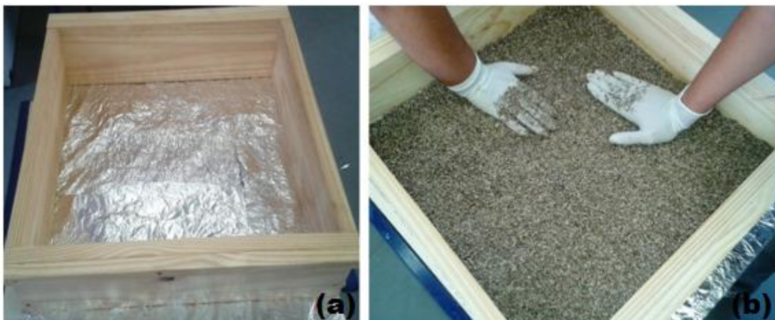
Figura 11- Fomação do colhão de partículas: (a)caixa formadora e (b) distribuição das partículas.
