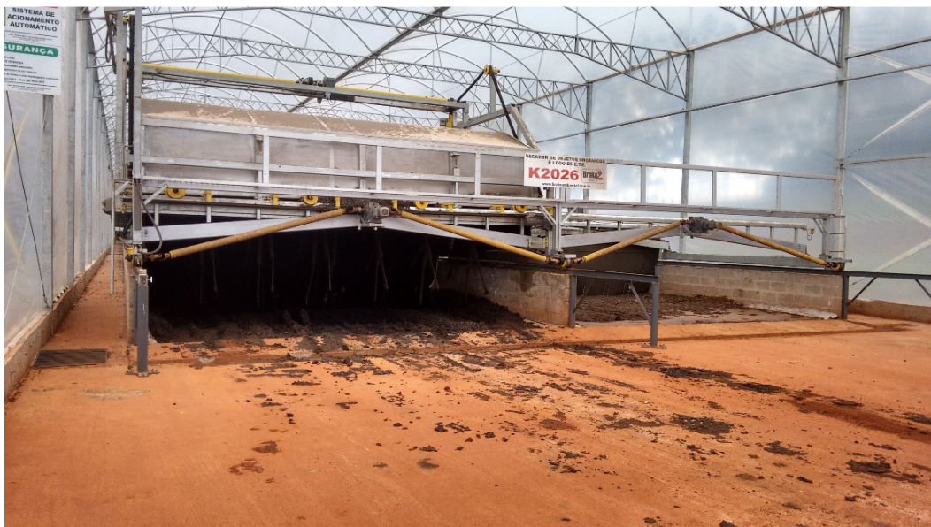
Figura 6 - Equipamento de revolvimento e secagem Fonte: Acervo pessoal, 2015.
