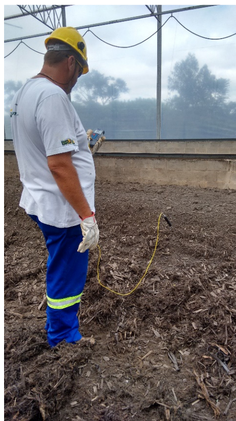
Figura 7 - Medição de temperatura Fonte: Acervo pessoal, 2015.
