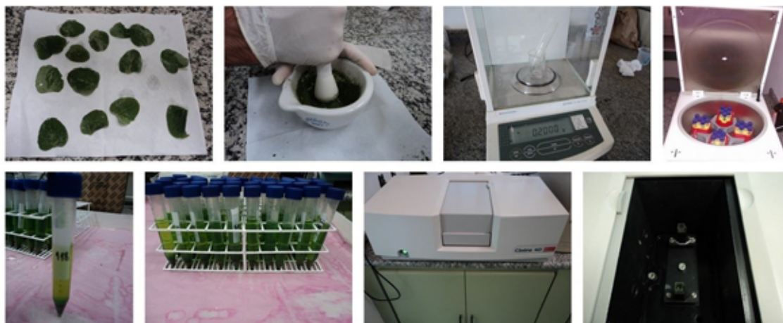
Figura 8. Detalhe do processo de extração de pigmentos de folíolos de soja e determinação da concentração de clorofila a , b e carotenoides em espectrofotômetro.
