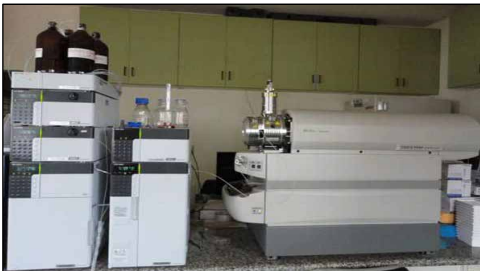
Figura 6. Cromatógrafo Líquido (Prominence UFLC) acoplado ao espectrômetro de massas (3200 Q TRAP) – LC-MS/MS.
