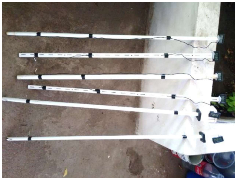
Figura 6 – Termômetros adaptados com hastes para medição da temperatura nas composteiras.
