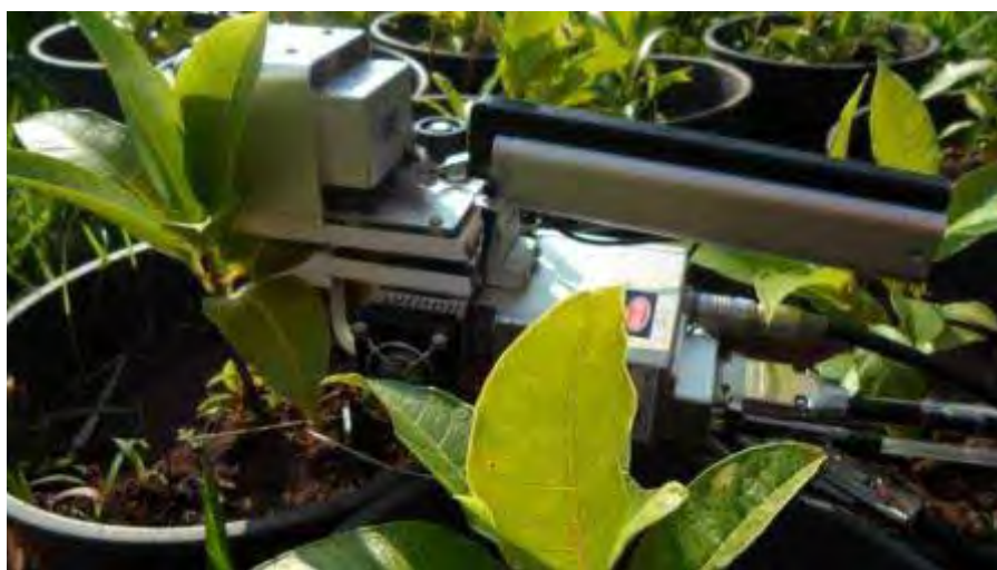
Figura 12. Radiação fotossinteticamente ativa (PAR) sob cada nível de sombreamento sendo determinada com analisador de gás infravermelho portátil (IRGA-LI 6400). UNESP/Botucatu-SP, 2011(Foto: Gabriela Granghelli Gonçalves, 2011).
