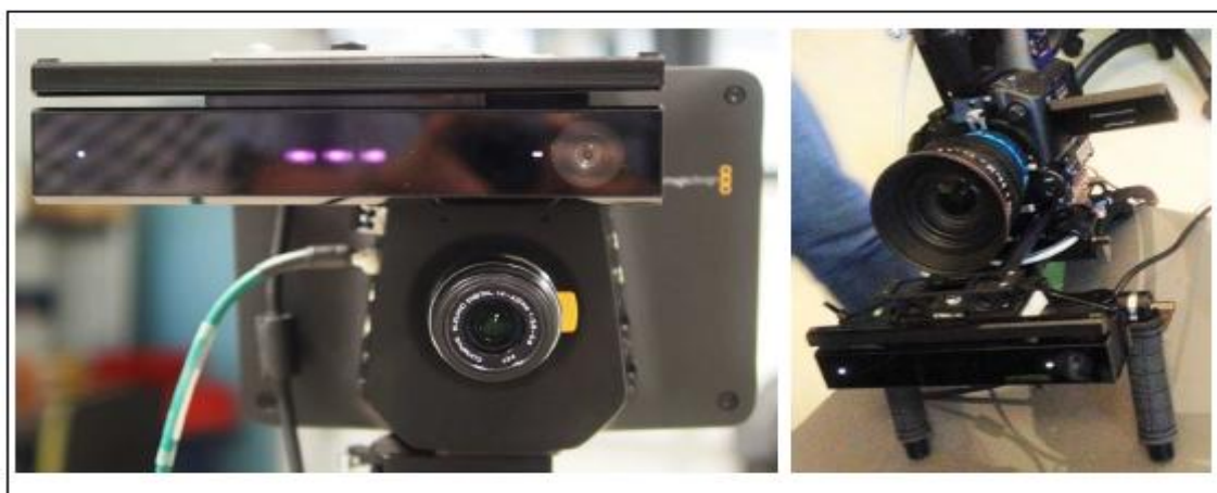
Figura 11 - Suportes para a câmera RGB com o Kinect v2
