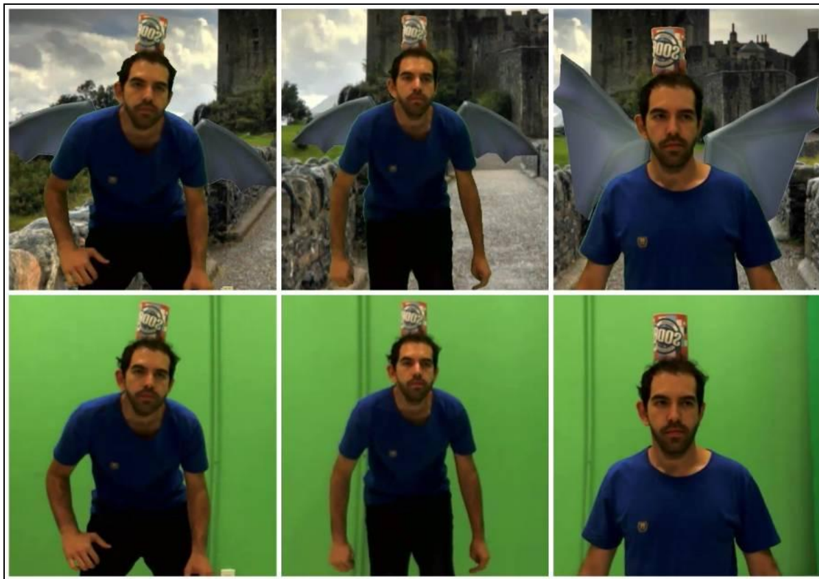
Figura 51 - Experimento de um marcador cilíndrico com a técnica de renderização por camadas e o objeto virtual atrás do corpo do ator
