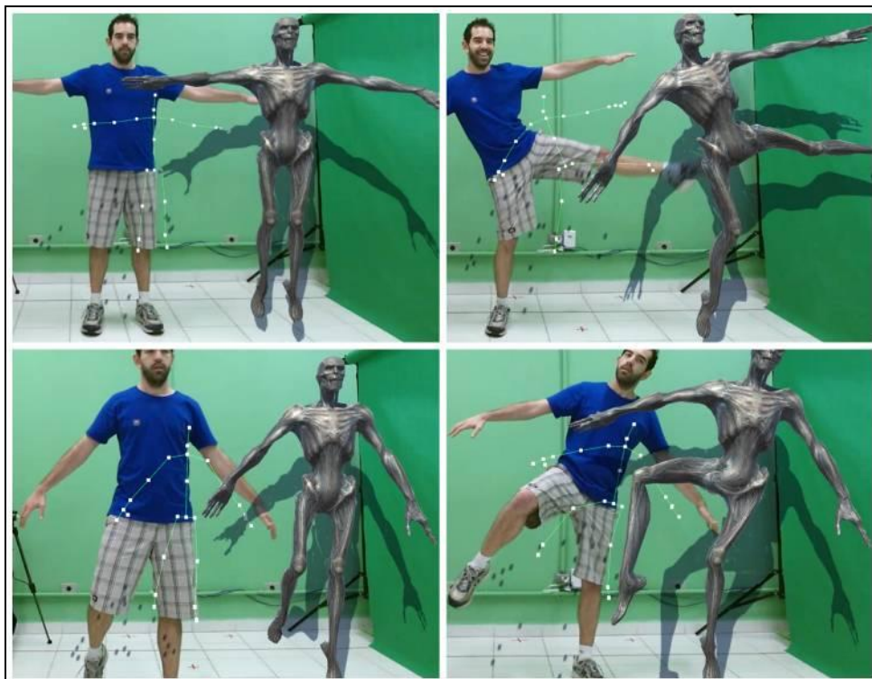
Figura 60 – Experimento de captura de movimentos e a transposição desses movimentos em um humanoide virtual
