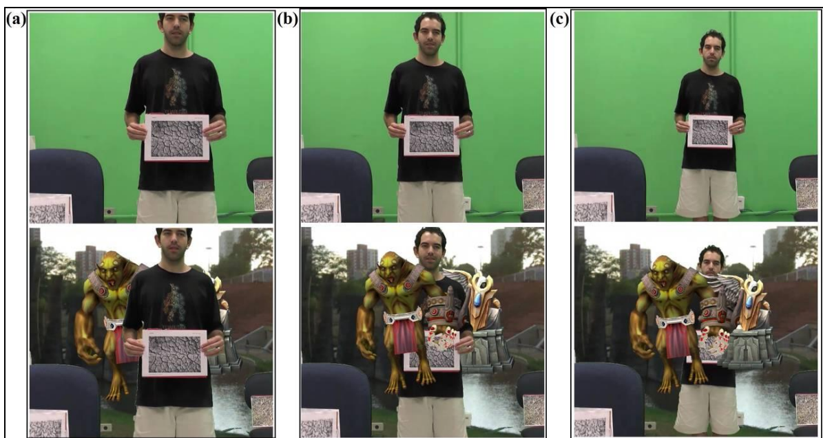
Figura 41 - Experimento da realidade aumentada com a oclusão mútua: a) ator em frente aos objetos virtuais; b) ator entre os objetos virtuais; c) ator atrás dos objetos virtuais
