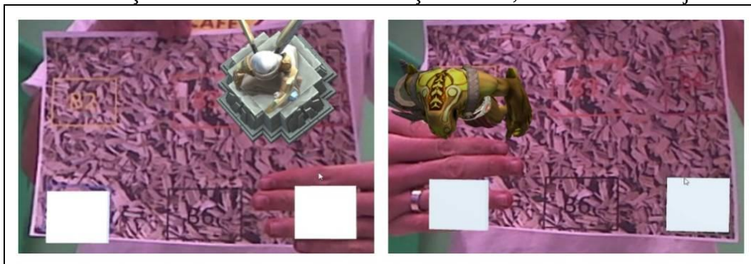
Figura 55 - Utilização de botões virtuais na interação do ator, trocando entre objetos virtuais
