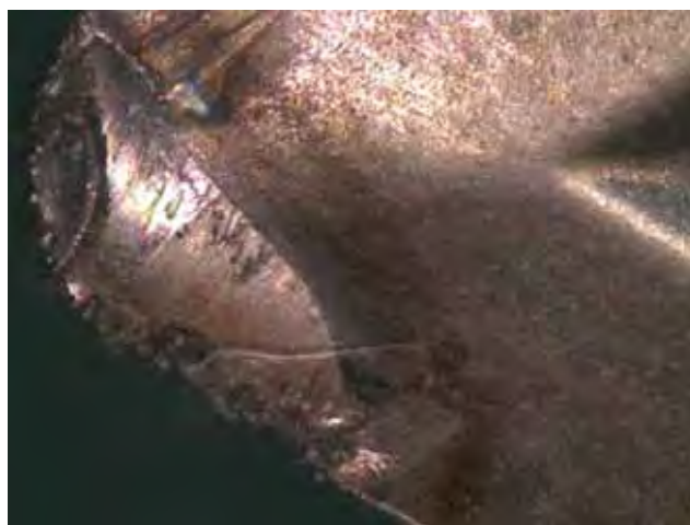
Figura 3.14 - Desgaste de cratera em uma ferramenta de metal duro sem recobrimento na usinagem do Nimonic 80A – v_c = 90 m/min., f = 0,18 mm/rot. e a_p = 1,6 mm (Faria, 2007).
