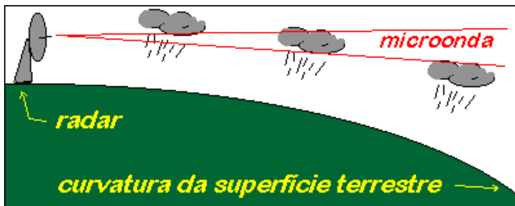
Figura 2 – Princípio do radar meteorológico, mostrando o feixe de radar relativo a superfície da terra atingindo grandes distâncias.
