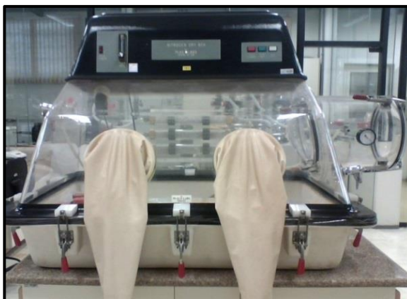
Figura 8 - Câmara Seca (Glove box) utilizada para manuseio dos reagentes em atmosfera inerte de \text{N}_2 .
