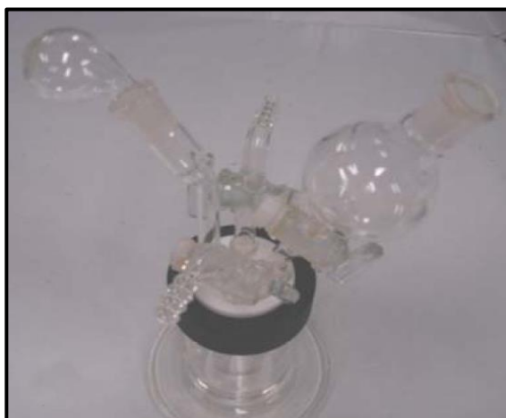
Figura 7 - Sistema reacional desenvolvido para a síntese dos derivados de politiofeno em atmosfera inerte de \text{N}_2 .
