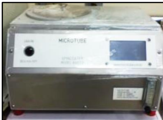
Figura 10 - Equipamento Spinner usado na preparação dos filmes pelo método spin coating. Fonte: Autora.
