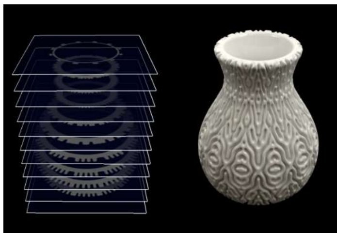
Figura 8 - Fatiamento do modelo CAD em camadas planas
