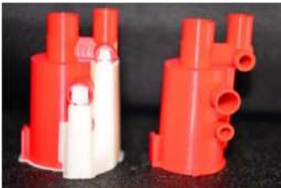
Figura 15 - Exemplo de peça impressa com tecnologia de extrusão de material e suporte (material PVA)
