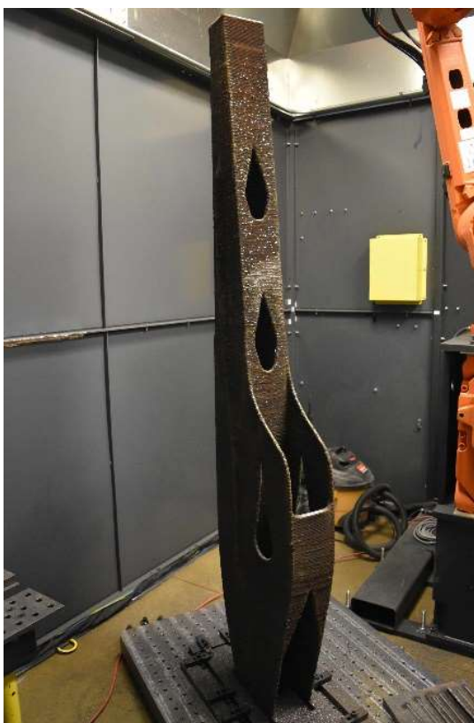
Figura 10 - Peça impressa em 3D com material metálico (deposição de metal a laser)
