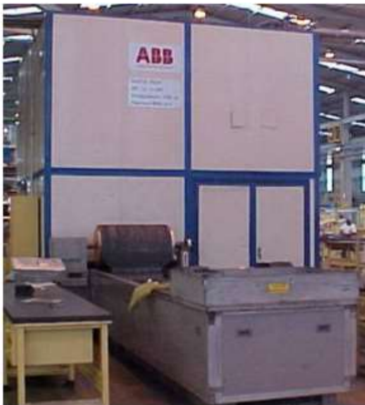
Figura 28 - Prensa com diafragma de borracha similar a empregada na execução dos ensaios
