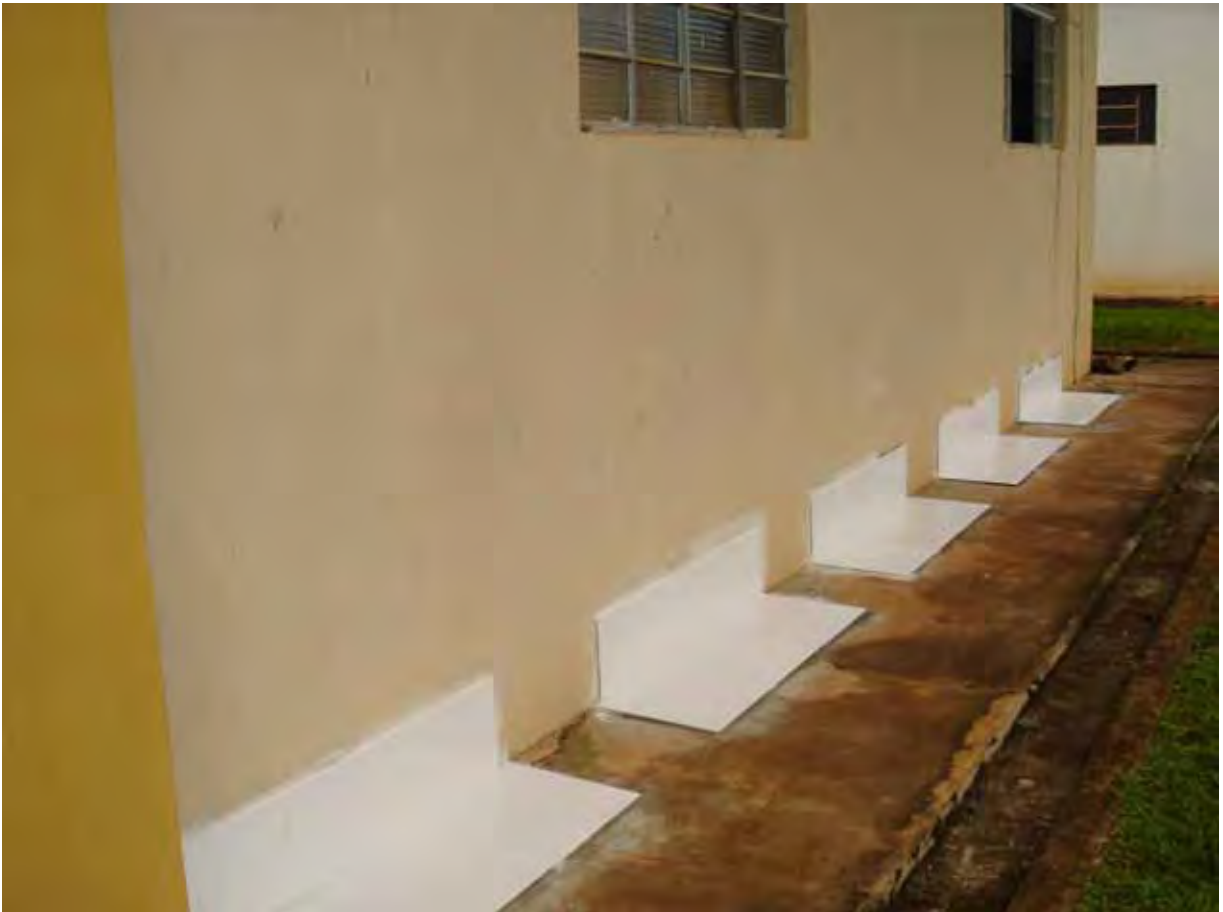
Figura 1. Superfície revestida de azulejo simulando o canto de uma parede, construída no lado externo do Laboratório de Ciência de Plantas Daninhas do Depto. Fitossanidade contendo cada parcela 2 m 2 (2mx1m). Jaboticabal, SP, 2007.
