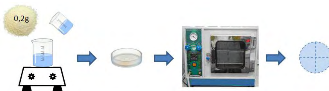
Figura 13. Preparo dos filmes de PVC e PCL por evaporação.
