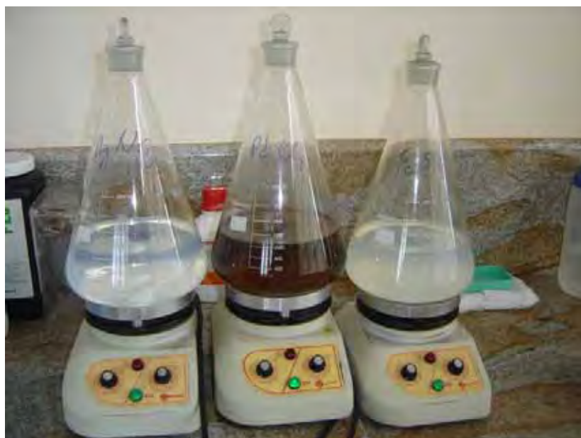
Figura 12. Peptização dos colóides de \text{TiO}_2 obtidos a partir da hidrólise do tetraisopropóxido de titânio.
