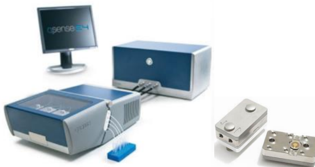
Figura 9: Componentes básicos da microbalança Q-Sense™ E4.
