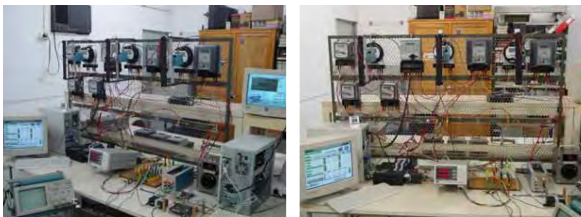
Figura 3.11 - Fotos do “arranjo geral de ensaio” para os medidores de energia eletrônicos
