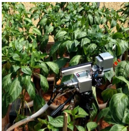
Figura 9- Medições de trocas gasosas, no período da manhã (09:00 e 11:30 horas) com auxílio do medidor portátil de trocas gasosas Mod. IRGA LI-6400
