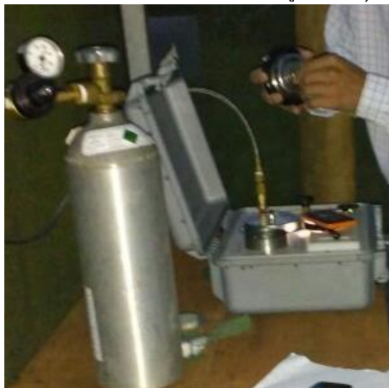
Figura 7- Medição do potencial da água no xilema das folhas ( \Psi_{\text{hfolha}} ) antes do amanhecer 5:00 am ( predawn ).
