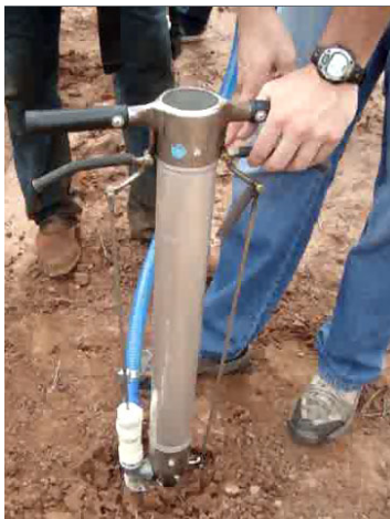
Figura 1. Plantadeira manual com aplicador de hidrogel acoplado. Botucatu/SP, 2009.
