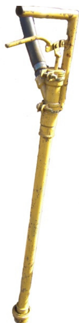
Figura 3. Aplicador tipo “chuveirinho” de hidrogel via irrigação.
