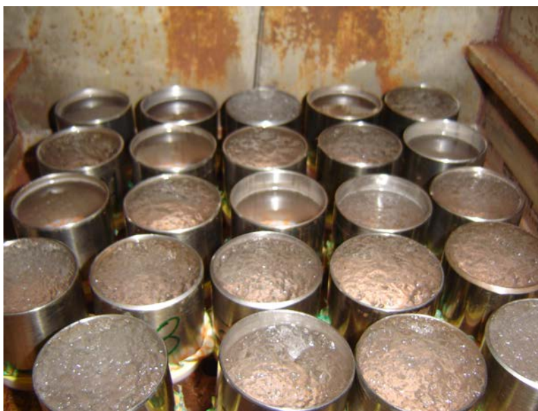
Figura 7. Anéis volumétricos com hidrogéis constituídos com diferentes doses de polímero em estufa de circulação forçada de ar a 65°C.
