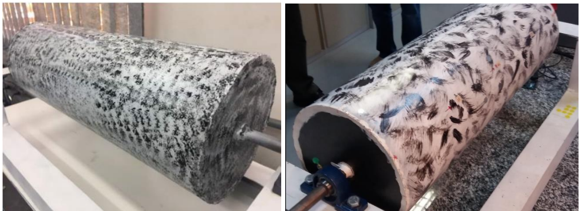
Figura 28 - Textura feita no cilindro: CDP-1 (esquerda) e CDP-2 (direita).
