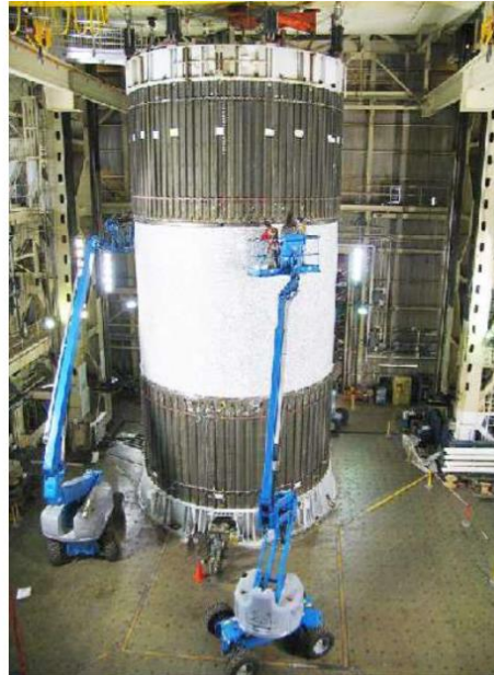
Figura 6 – Detalhe da montagem do corpo de prova (SLS)
