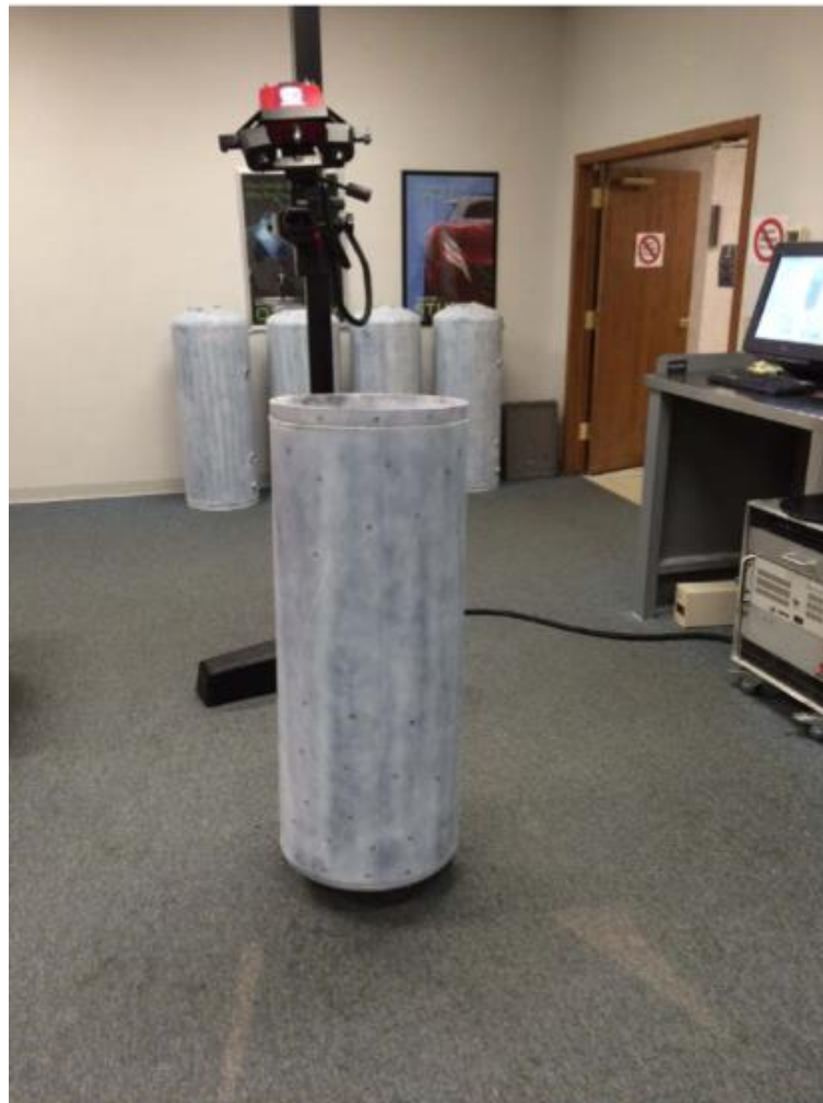
Figura 19 - Mapeamento geométrico utilizando blue scanner
