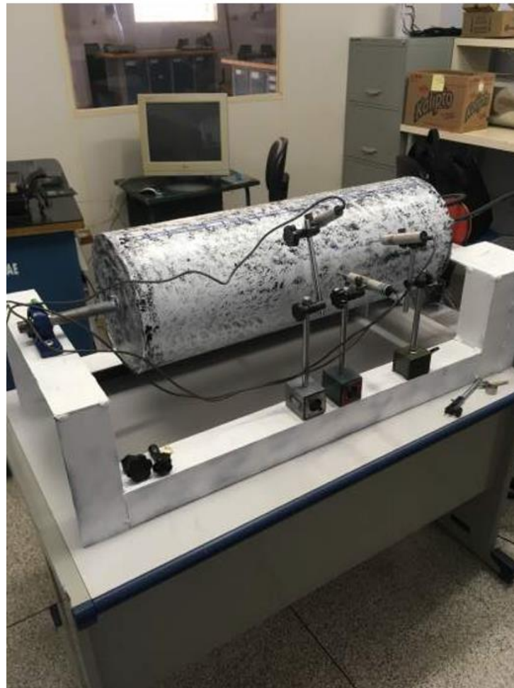
Figura 34 - Bancada experimental com sensores LVDT posicionados em pontos pré-determinados.
