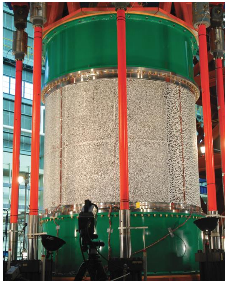
Figura 7 – Detalhe da captura dos deslocamentos, corpo de prova hachurado.
