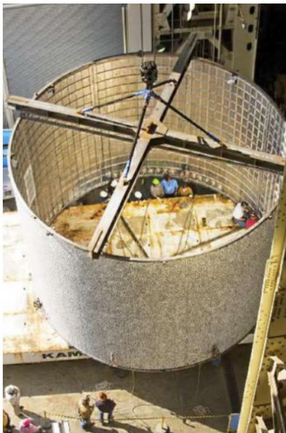
Figura 6 – Detalhe da montagem do corpo de prova (SLS)
