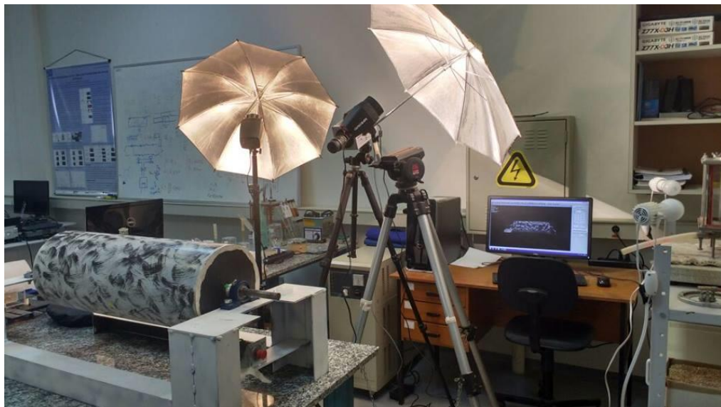
Figura 35 – Bancada de fotovelocidade montada
