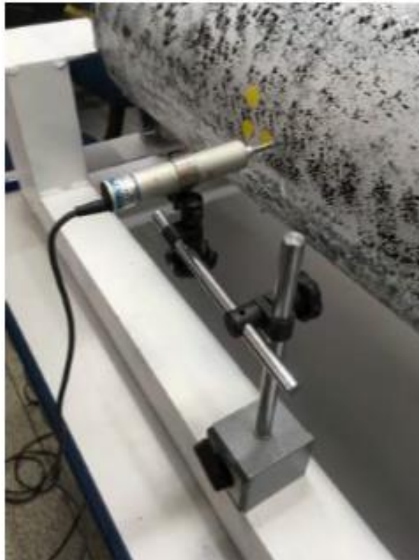
Figura 27 - Mapeamento da geometria com sensor LVDT.
