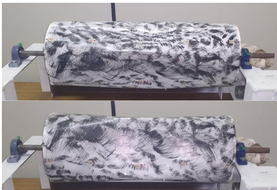
Figura 58 – Modo de flambagem apresentado pelo CDP-2 no ensaio experimental.
