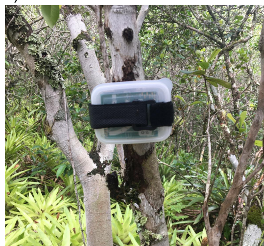
Figura 2. Gravadores autônomos AudioMoth, versão 1.1.0, utilizados para coletar os dados acústicos. A) unidade exposta; B) unidade presa a uma árvore na Restinga Baixa.
