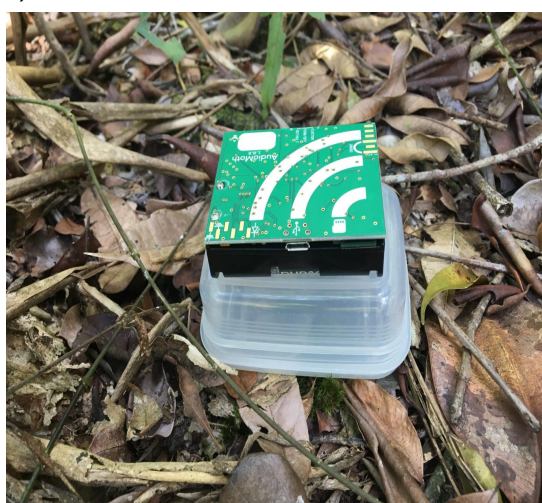
Figura 2. Gravadores autônomos AudioMoth, versão 1.1.0, utilizados para coletar os dados acústicos. A) unidade exposta; B) unidade presa a uma árvore na Restinga Baixa.
