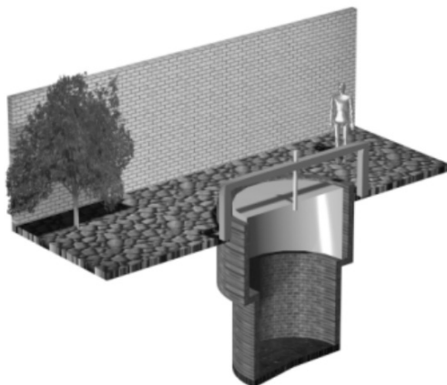
Figura 5 - Representação de um biodigestor modelo batelada (Deganutti et al., 2002).
