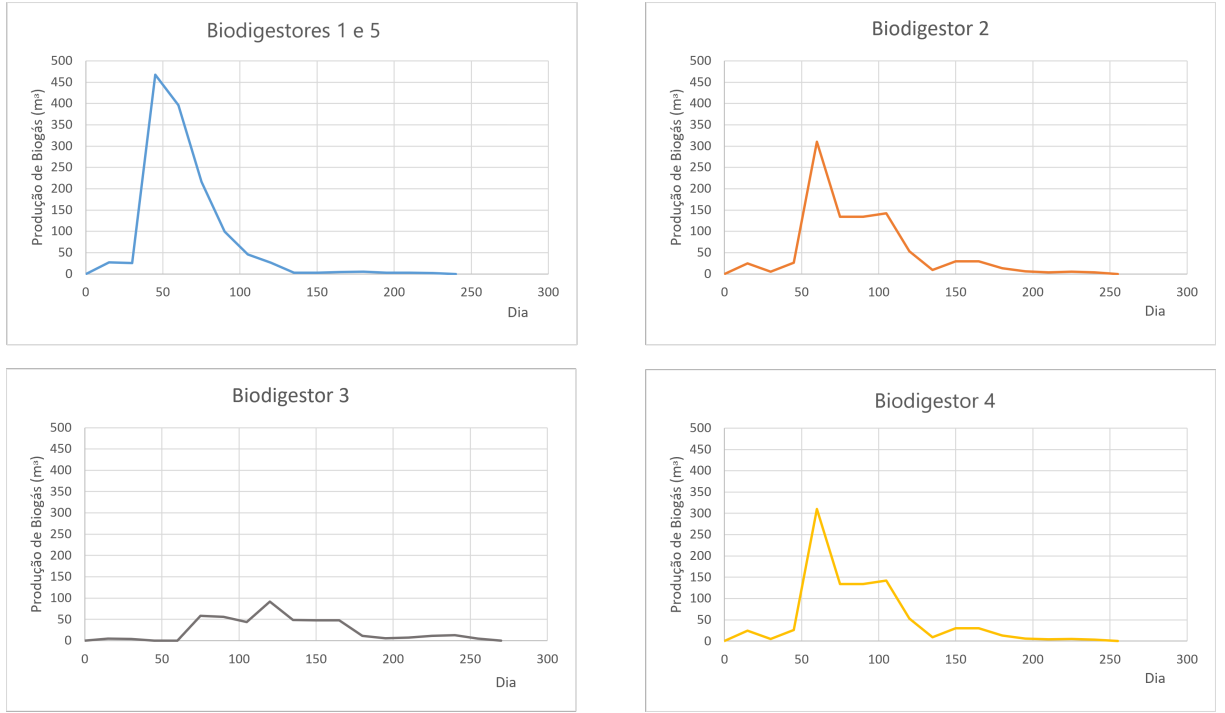
Figura 9 - Curva de produção de biogás, P_j(x) , de cada biodigestor em cada tempo x , x \in [0, r_j] , j = 1, \dots, 5 .
