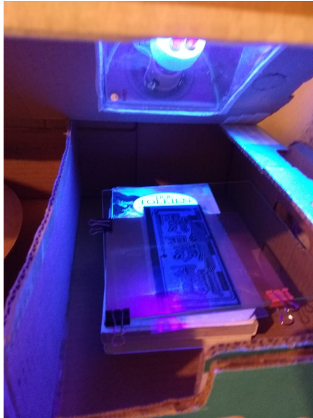
Figura 4.3: Sensibilização da tinta fotossensível por lâmpada UV. Fonte: Autoria Própria 2018.
