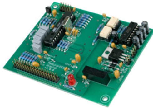
Figura 3.27: placa Open EEG. Fonte: (OPENEEG, 2016)
