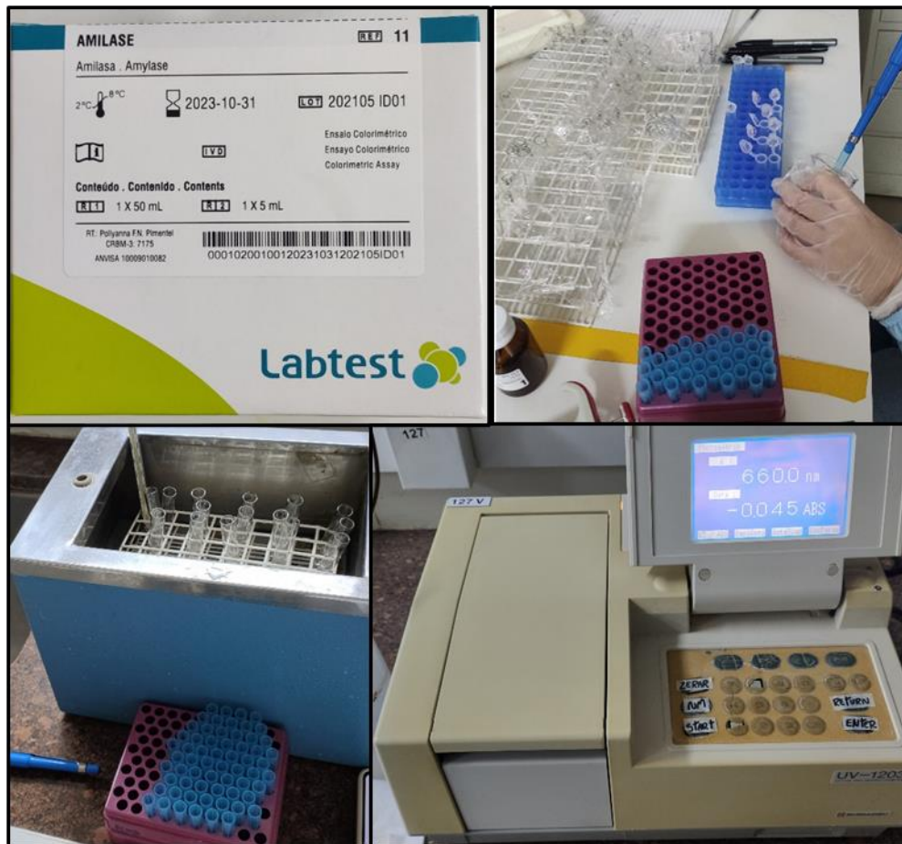
Figura 12 – Kit da amilase, processamento das amostras, banho maria em 37 das amostras e espectrofotômetro.
