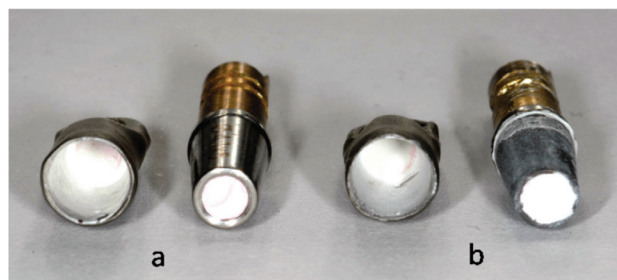
Figura 4 - Espécimes já ensaiados: (a) original; (b) irradiado.
