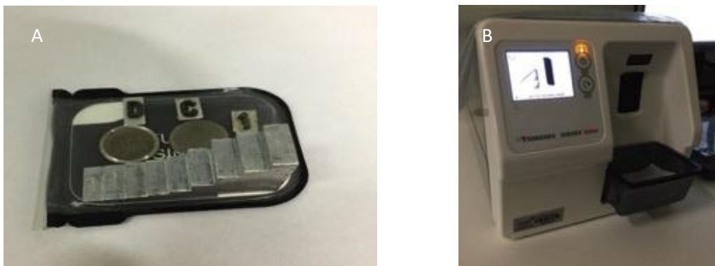
Figura 2. Corpos de prova e escada de alumínio preparados para serem radiografados (A); Equipamento utilizado para processamento e digitalização das imagens radiográficas (B) (Digora 1.51, Soredex (Orion Corporation , Helsínquia , Finlândia))
