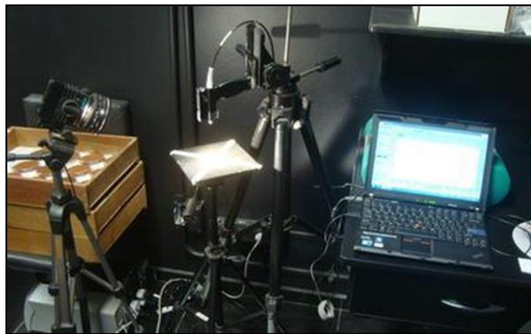
Figura 22. Sistema de aquisição das assinaturas espectrais das amostras de TFSA em placas petri (Fonte: Biblioteca Espectral de Solos do Brasil - BESB).
