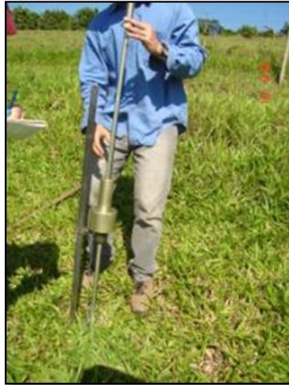
Figura 14. Experimento com penetrômetro de impacto em área com pastagem. (Fonte: Isabel Cristina Moraes).
