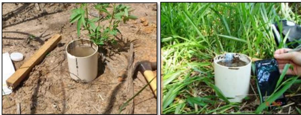
Figuras 13a e 13b. Experimento com infiltrômetro em área com cultivo de cana-de-açúcar e pastagem. (Fonte: o autor e Isabel Cristina Moraes).
