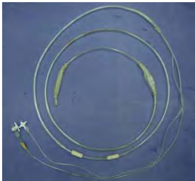
Figura 2 – Cateter com dois balões (CB) confeccionado artesanalmente com tubo de polietileno para a determinação in vitro das curvas de complacência dos balões esofágico e gástrico e aferição das pressões pleural e gástrica. UNESP – Jaboticabal, 2008.
