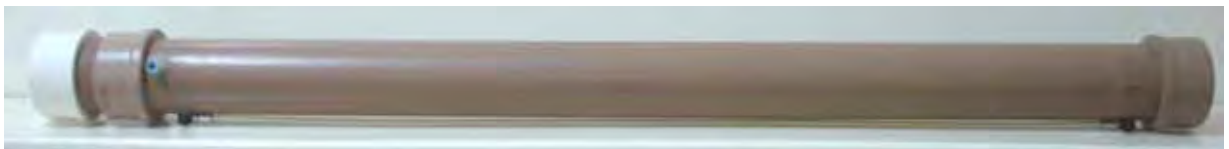
Figura 4 – Tubo de cloreto de polivinila (pvc) confeccionado artesanalmente para a determinação in vitro das curvas de complacência do balão gástrico. UNESP – Jaboticabal, 2008.
