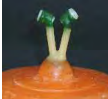
FIGURA 7- CORPOS-DE-PROVA MONTADOS NA BASE FORMADORA DE CADINHO.
