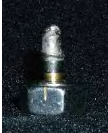
FIGURA 12- CORPO-DE-PROVA PARAFUSADO SOBRE MINIPILAR E IMPLATE FIXADOS EM BASE METÁLICA HEXAGONAL
