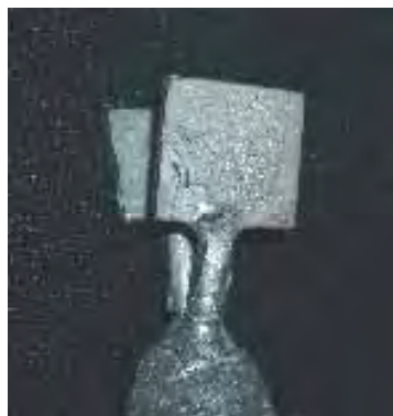
FIGURA 3- CORPOS-DE-PROVA FUNDIDOS PARA REALIZAÇÃO DO TESTE DE RUGOSIDADE
