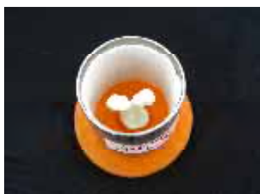
FIGURA 9- CORPOS-DE PROVA MONTADOS EM BASE FORMADORA DE CADINHO COM ANEL METÁLICO PREPARADO PARA INCLUSÃO.
