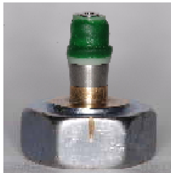
FIGURA 6- PADRÃO DE CERA ESCULPIDO E PARAFUSADO SOBRE MINIPILAR E IMPLANTE MONTADOS EM BASE METÁLICA HEXAGONAL.
