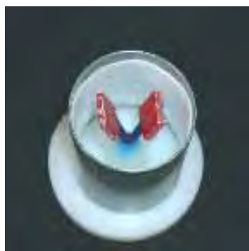
FIGURA 2- PADRÕES DE RESINA PATTERN PREPARADOS PARA INCLUSÃO
