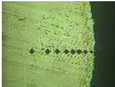
FIGURA 5- MARCAS DO RASTREAMENTO PARA MEDIDA DE DUREZA VICKERS
