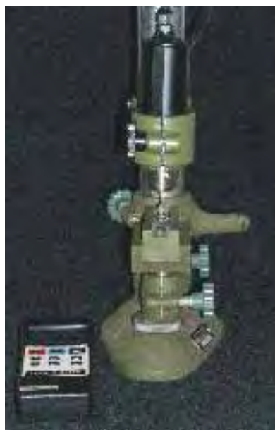
FIGURA 11- APERTO DO PARAFUSO DE TITÂNIO NO CORPO-DE-PROVA DE ADAPTAÇÃO COM TORQUÍMETRO DIGITAL
