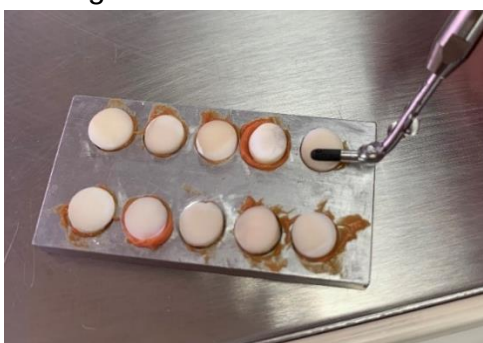
Figura 5 - Ponta diamantada CVDentus CR4 acoplada em ultrassom (US) Clinical Plus – Dent Surg para realizar o desgaste na amostra
