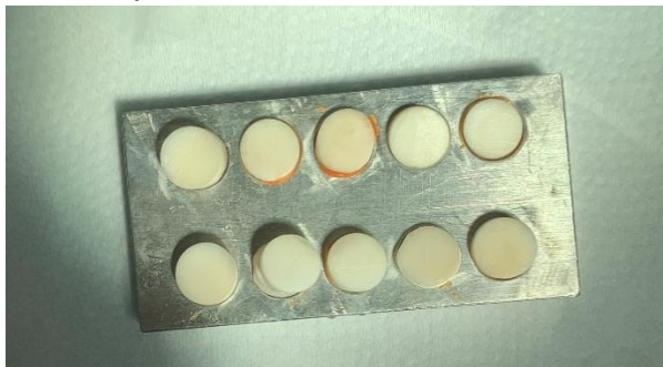
Figura 4 - Amostras circulares posicionadas nos orifícios da base metálica. Uma camada de silicone foi usada para melhorar a estabilidade das amostras nos orifícios.
