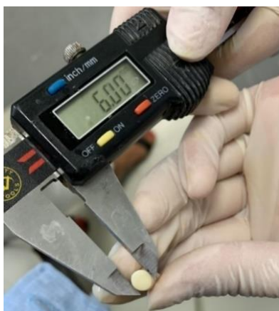
Figura 3 - Conferência da medida da amostra circular sendo com um paquímetro digital
