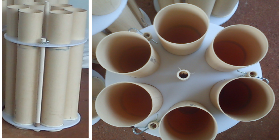
Figura 5. Coletores de Tripton com 23,55 L e 392.5 cm 2 de superfície.
