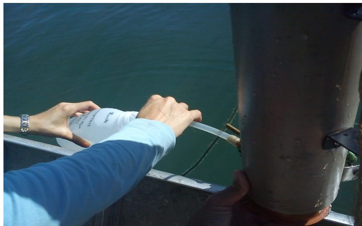
Figure 4. Coleta de água usando uma garrafa de van Dorn a 1,5m de profundidade.
