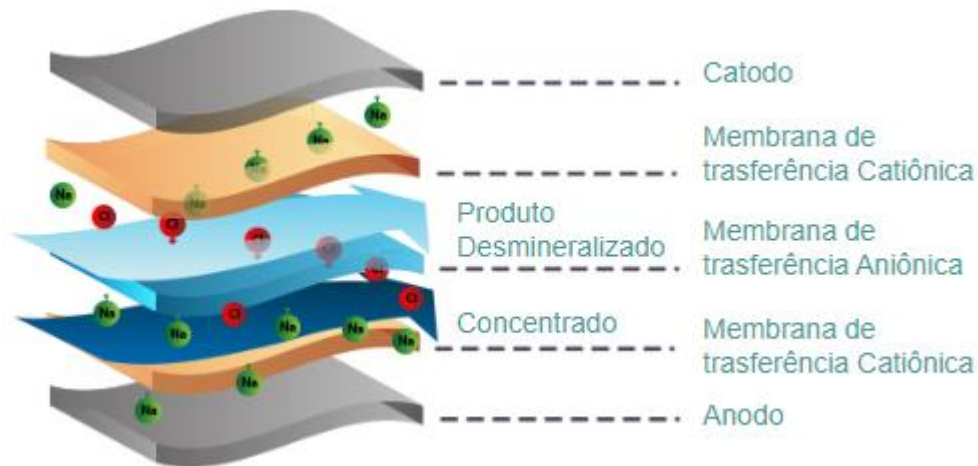
Figura 5: Representação da eletrodialise
