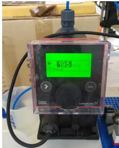
Figura 20: Fotografia da Bomba dosadora utilizada nos ensaios
