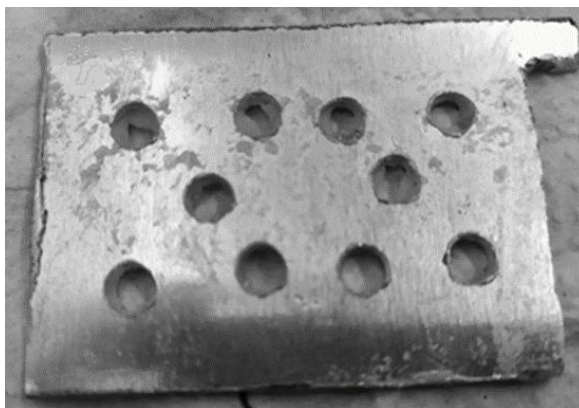
Figura 23: Eletrodo utilizado nos experimentos de EF
