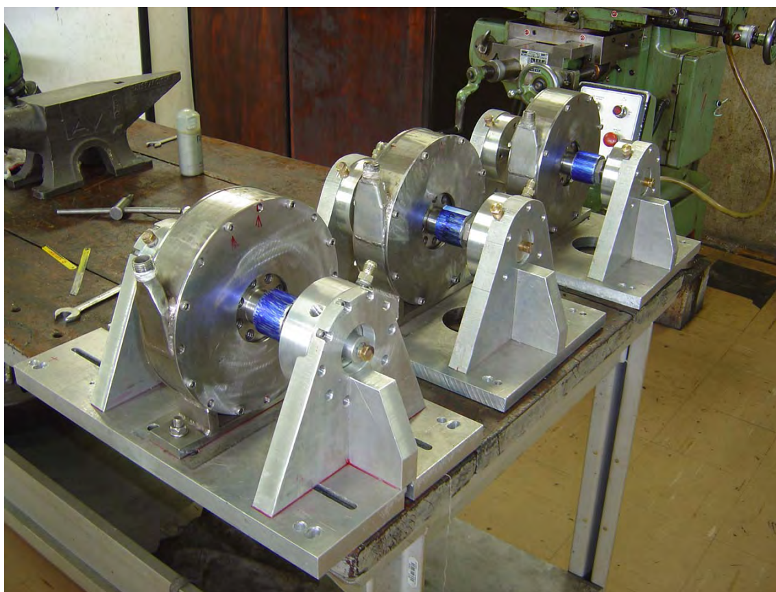
Figura 47 - Detalhe da montagem das Turbinas Tesla e Tesla-Pelton
