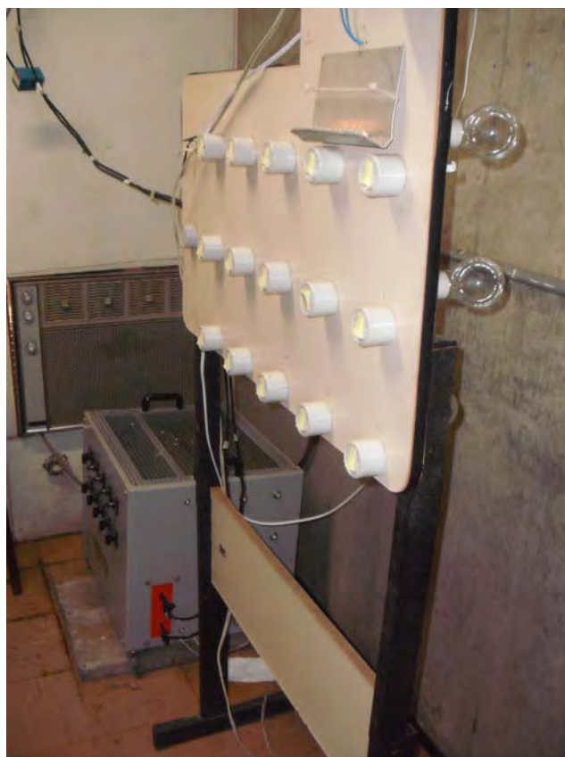
Figura 50 - Banco de resistências.
