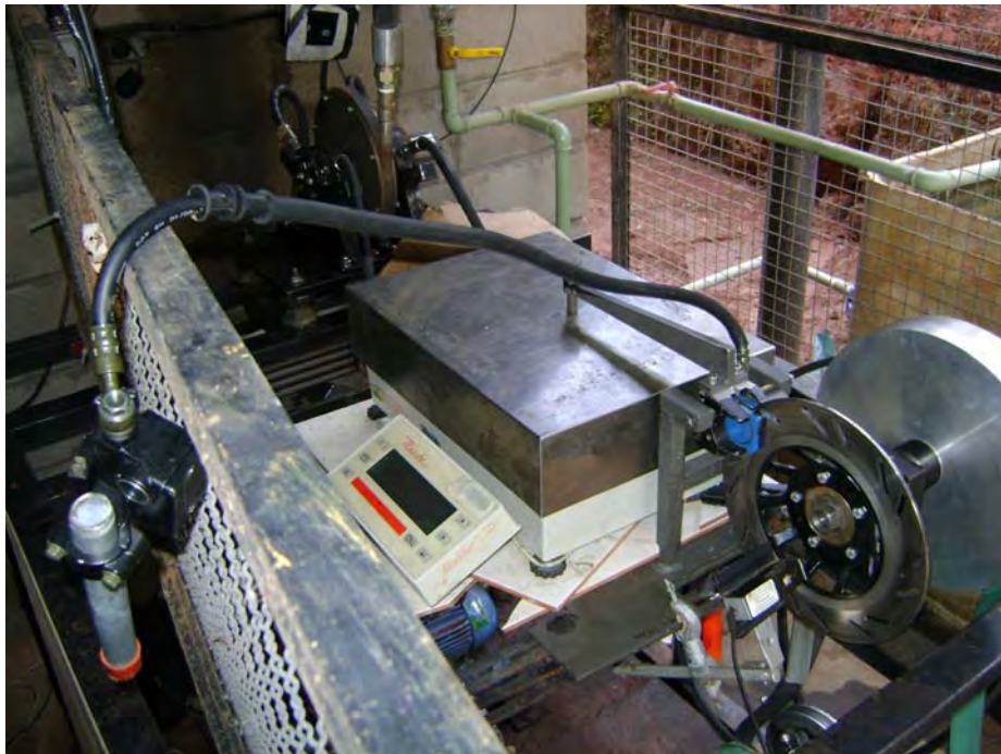
Figura 55- Sistema para medir o torque da turbina composto por freio, haste e balança.
