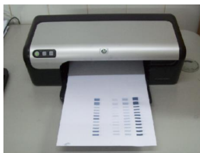
Figura 16 - Foto da impressora HP Deskjet D2460, utilizada para deposição jato de “tintas” de PANI e PEDOT.
