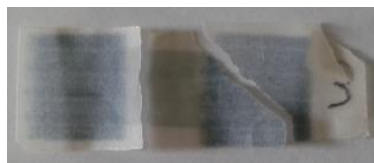
Figura 42 – Fotografia de um dispositivo impresso sobre o papel vegetal após o processo de dopagem
