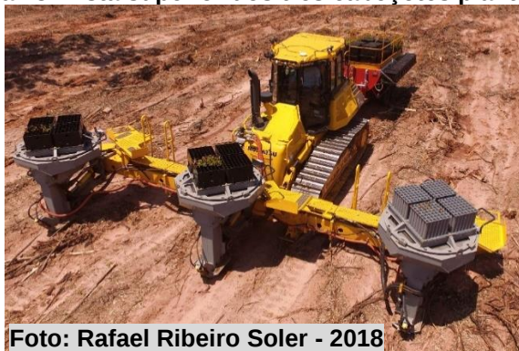
Figura 13. Vista superior dos três cabeçotes plantadores
