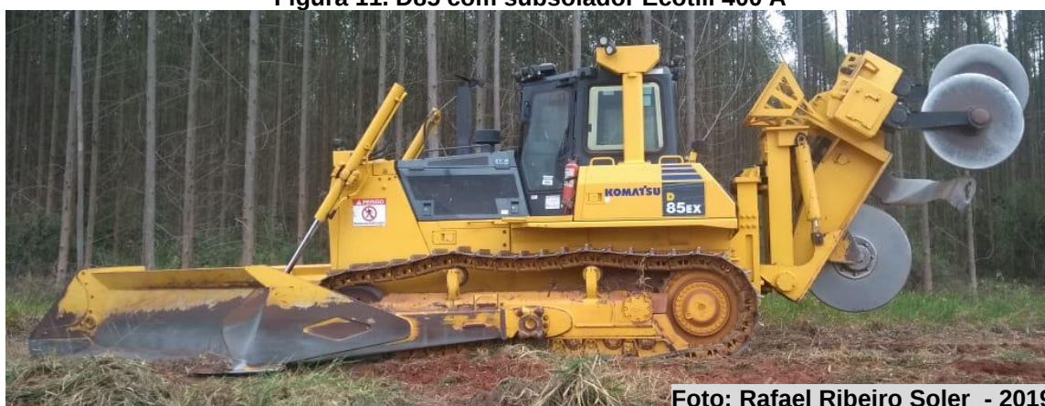
Figura 11. D85 com subsolador Ecotill 400 A
