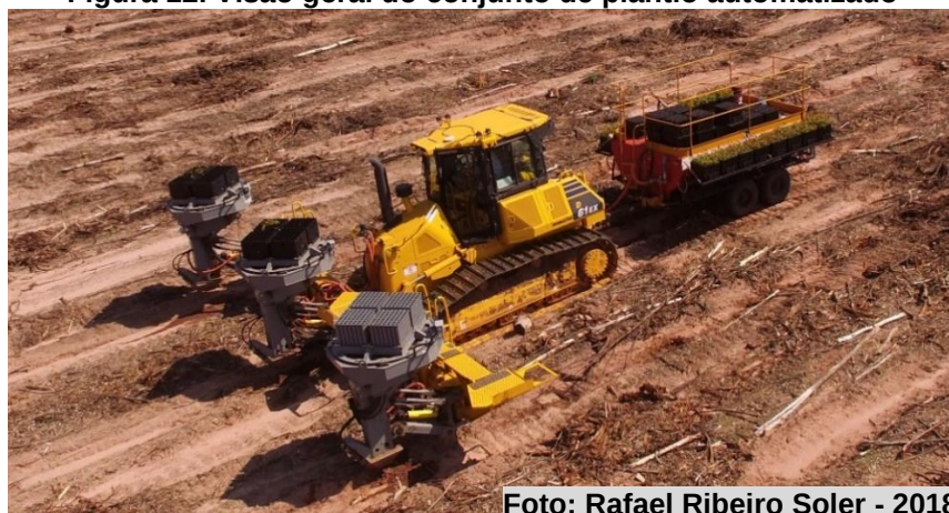
Figura 12. Visão geral do conjunto de plantio automatizado
