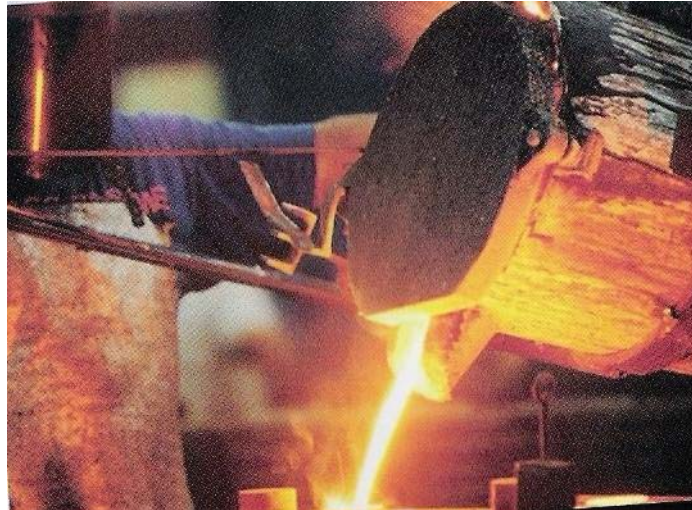
Figura 16: Vazamento de alumínio no molde (ABAL, 2007).
