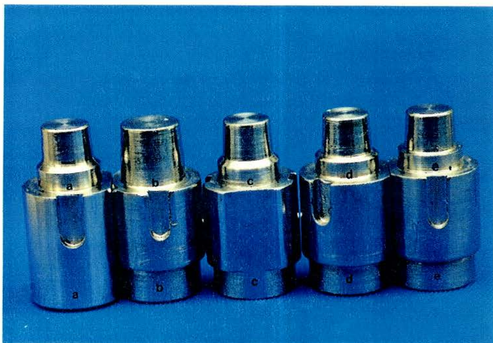
FIGURA 6 - Modelos-padrão torneados respeitando a média de dimensão de um segundo molar inferior com término cervical conforme proposição, na seqüência: a) chanfro; b) gume de faca; c) plano inclinado; d) ombro biselado; e) ombro retro.
