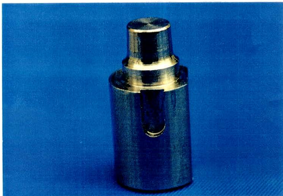
FIGURA 8 - Modelo-padrão apresentando término cervical do preparo em chanfro formando uma concavidade de 1,02^{\circ} com as paredes axiais.
