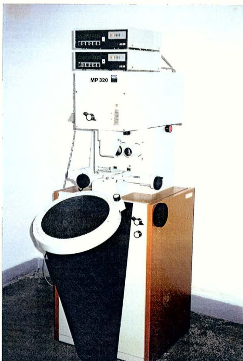
FIGURA 3 - Projetor de perfil MP 320 Carlzeiss, Germany, resolução 0,001mm.
