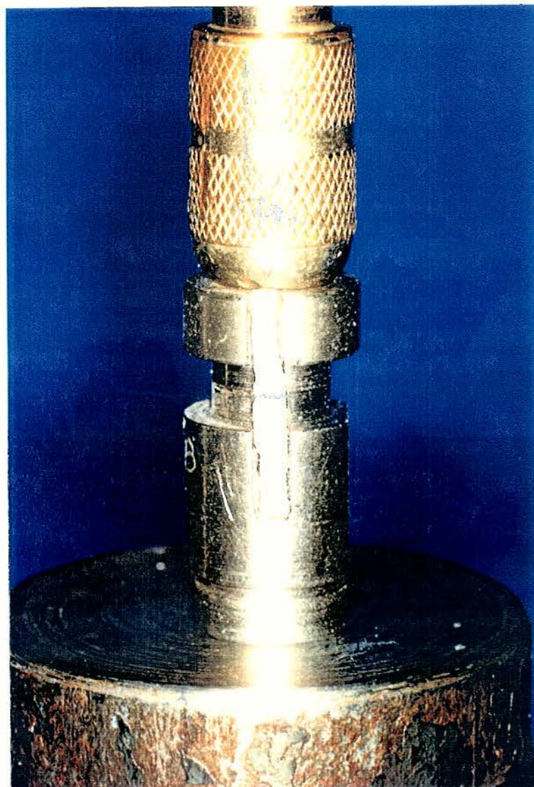
FIGURA 17 - Detalhe dos corpos-de-prova (modelo-padrão e cápsula metálica), ainda sob a carga de 5 kg, sendo travado através das hastes metálicas colocadas no sulco guia posicionado verticalmente na parede externa do conjunto.
