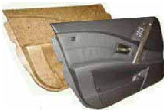
Figura 5: Fibras de curauá usadas em portas de carros. Fonte: FAO
