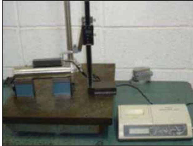
Figura 24: Rugosímetro Portátil, marca Mitutoyo, modelo SURFTEST-301.
