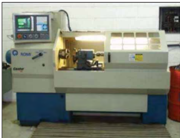
Figura 23: Máquina Ferramenta Torno CNC, Marca ROMI, Modelo Centur 30S.
