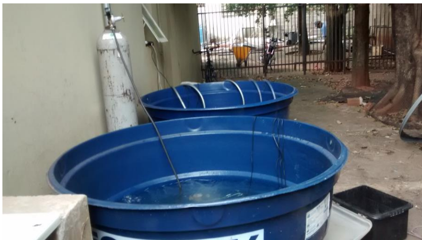
Figura 9: Bombeamento de nitrogênio gasoso nos tanques com o intuito de garantir a diminuição da concentração de O 2 dissolvido na água.
