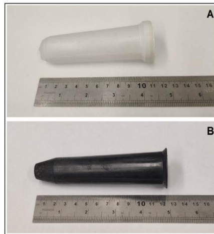
Fonte: Acervo particular dos autores (abril de 2021) Em que: A - tubete degradável SIS BGC; B - tubete de polietileno
