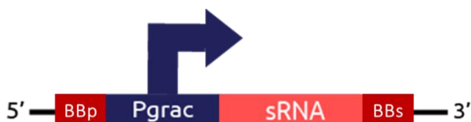
Figura 12- Representação da segunda unidade de transcrição contendo o sRNA específico projetado para os riboswitches de purinas e FMN sendo regulado pelo promotor grac , integrado ao locus lacA em Bacillus subtilis que contém o sistema riboswitch -operon lux nos genomas.
