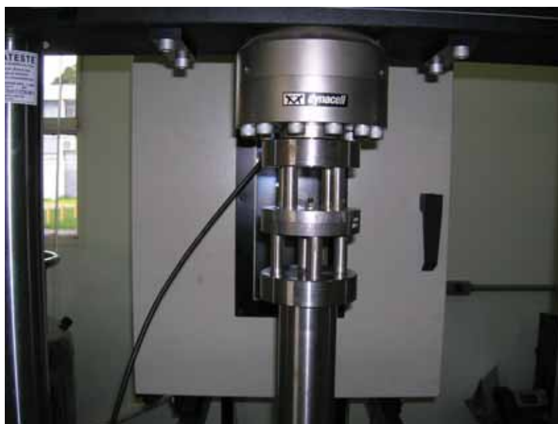
Figura 16 – Dispositivo de fadiga utilizado.
