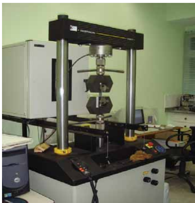
Figura 8 – Máquina de ensaios INSTRON, modelo 8801.
