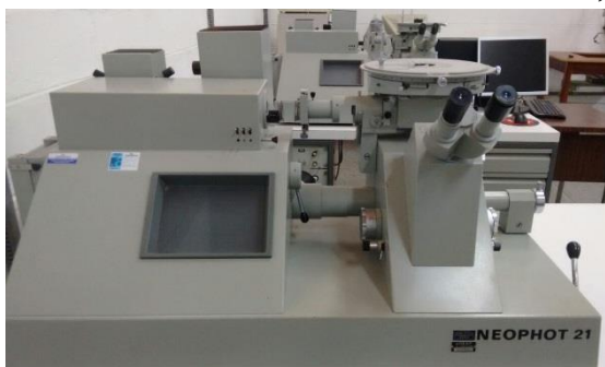
Figura 12 - a) Microscópio óptico, marca: ZEISS, modelo Neophot 21; b) Microscópio Eletrônico de Varredura, marca: Zeiss, modelo Evo LS15.
