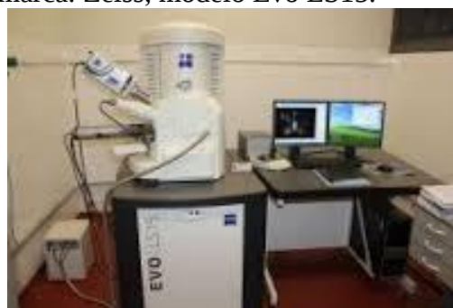
Figura 12 - a) Microscópio óptico, marca: ZEISS, modelo Neophot 21; b) Microscópio Eletrônico de Varredura, marca: Zeiss, modelo Evo LS15.
