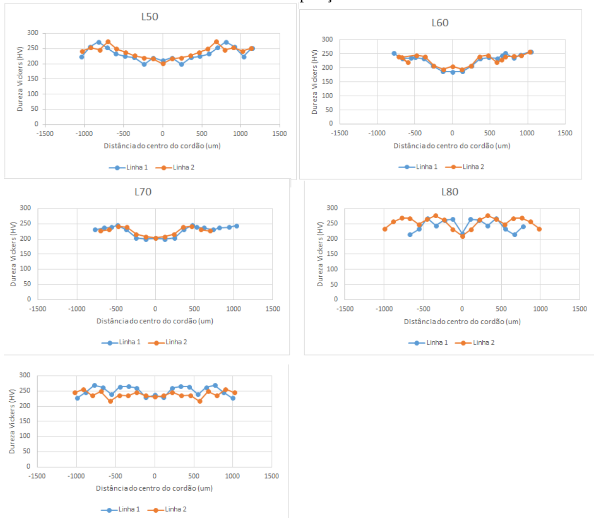
Figura 35 - Gráficos de Microdureza das Juntas Laser 316L com 50%, 60%, 70%, 80% e 90% de sobreposição.
