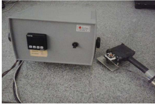
Figura 13 – Sistema utilizado no tratamento térmico das amostras. Do lado esquerdo, o controlador de temperatura e do lado direito o suporte que acopla a amostra no tratamento.
