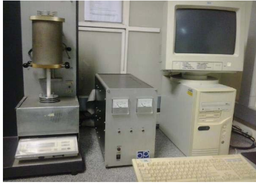
Figura 14 – Equipamento utilizado para termogravimetria.
