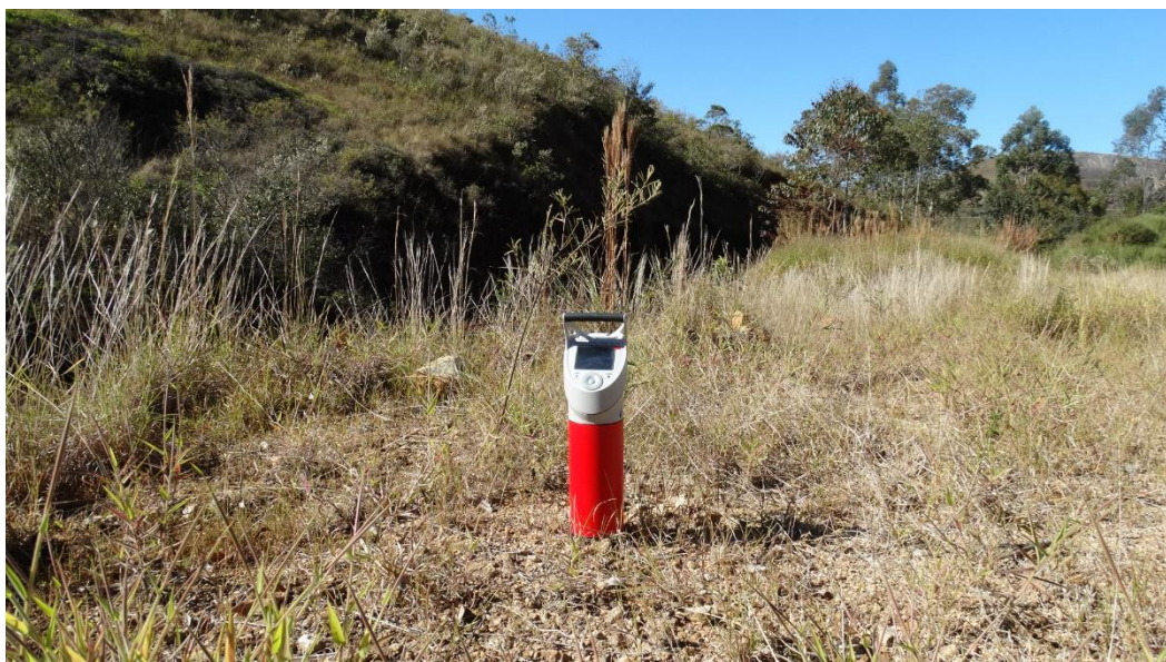
Figura 17. Gamaespectrômetro RS-332 durante coleta de dados na área de estudos
