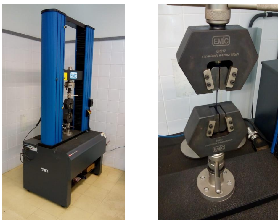
Figura 3.3: máquina universal do modelo EMIC 23-100
