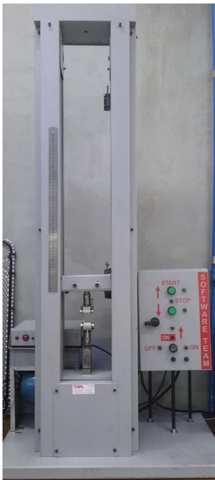
Figura 3.5: Dinamômetro - Team modelo DT 500. Fonte: próprio autor.
