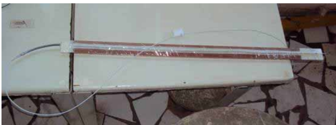
Foto 2 Sensor de 1,0 metro acoplado a ripa de madeira
