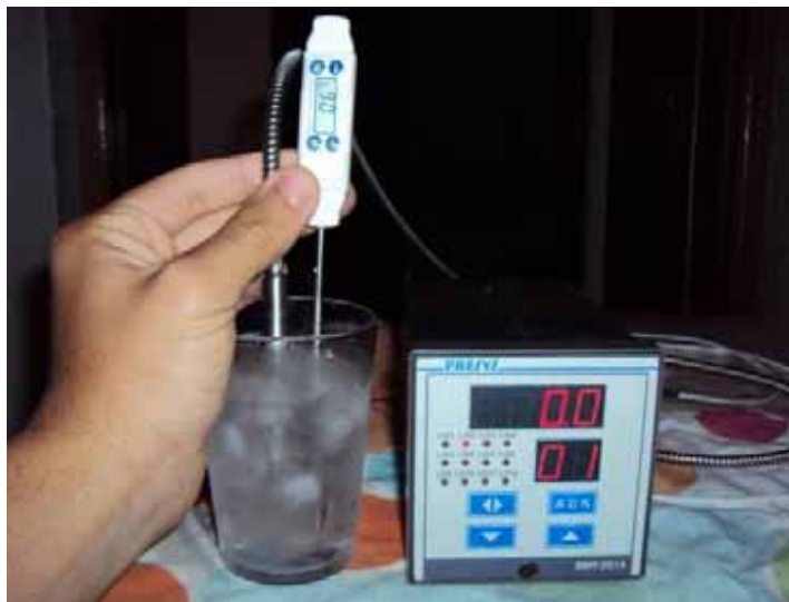
Foto 1 Calibração do Indicador Digital Multiponto
